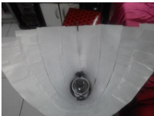
Figura 4.17 – Panela posicionada no interior do forno solar (autor, 2019)
