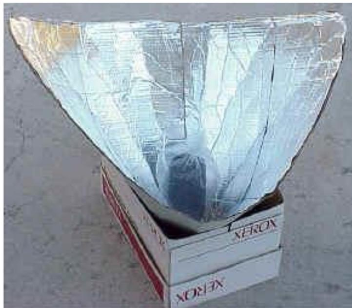
Figura 3.6 - Forno solar funil feito com papelão e folha de alumínio por Steven E. Jones (Adaptado de solarcooking, 2019)
