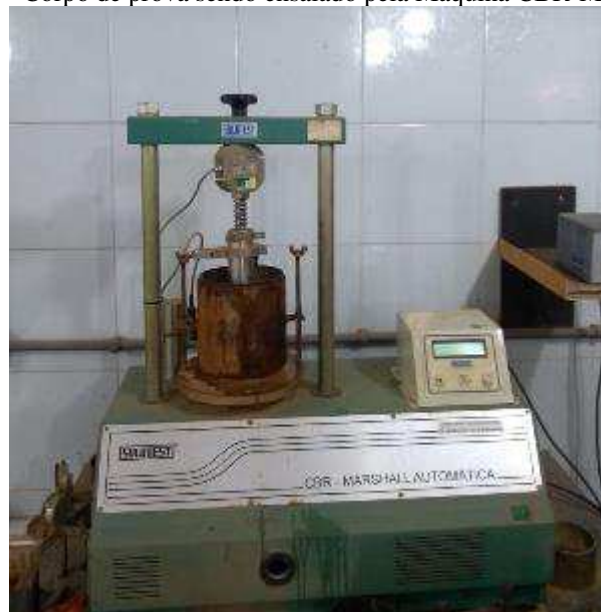
Figura 30 - Corpo de prova sendo ensaiado pela Máquina CBR-MARSHALL
