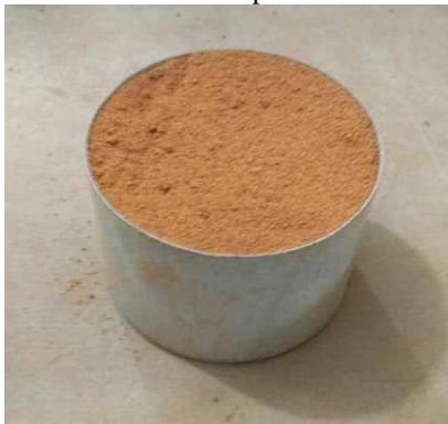
Figura 24 - Cápsula contendo amostra para ensaio de equivalente de areia
