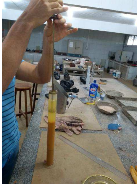
Figura 27 - Inserção da haste metálica para medição das alturas de areia e argila
