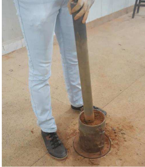
Figura 44 - Compactação de amostra solo-agregado
