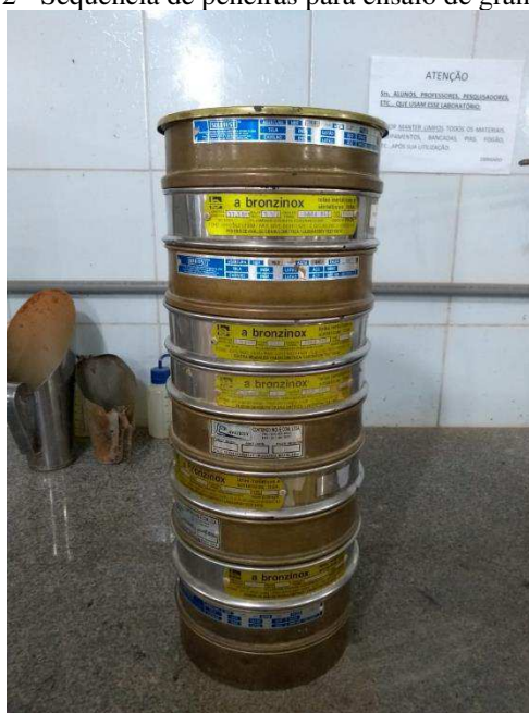
Figura 32 - Sequência de peneiras para ensaio de granulometria
