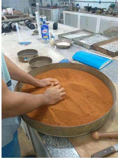
Figura 29 - Umedecimento e homogeneização de amostra para ensaio de compactação
