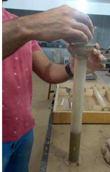
Figura 40 - Amostra sendo inserida na proveta para ensaio de equivalente de areia
