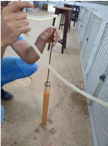
Figura 26 - Inserção de solução na proveta até à marca superior
