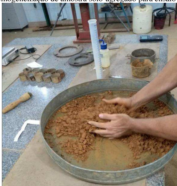
Figura 43 - Homogeneização de amostra solo-agregado para ensaio de compactação
