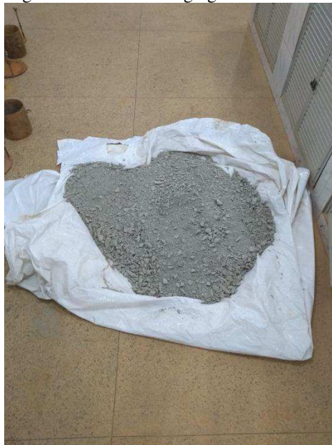
Figura 6 - Amostra de agregado bica corrida
