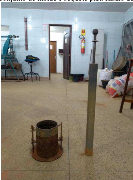
Figura 28 - Conjunto de molde e soquete para ensaio de compactação
