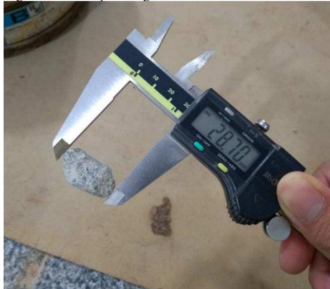
Figura 42 - Medição dos grãos do ensaio de índice de forma
