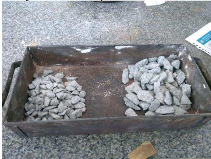
Figura 41 - Amostra final para ensaio de índice de forma
