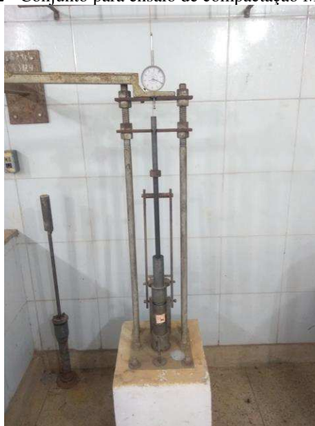
Figura 22 - Conjunto para ensaio de compactação Mini-Mcv
