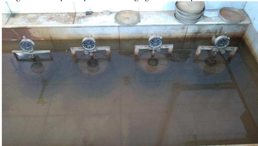
Figura 45 - Corpos de prova de solo-agregado imersos para ensaio de ISC
