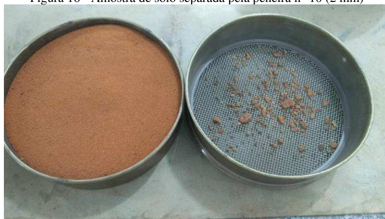
Figura 16 - Amostra de solo separada pela peneira n° 10 (2 mm)
