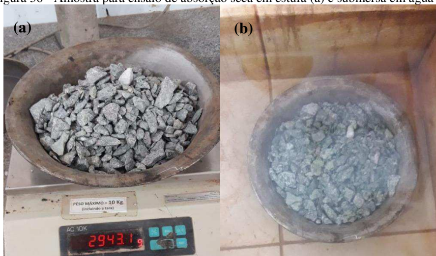
Figura 36 - Amostra para ensaio de absorção seca em estufa (a) e submersa em água (b)
