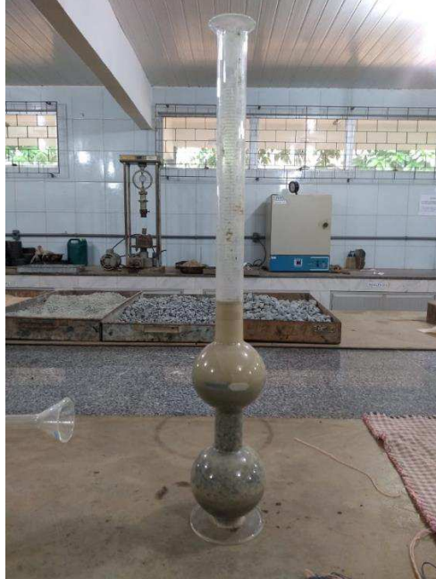
Figura 39 - Determinação da massa específica pelo frasco Chapman
