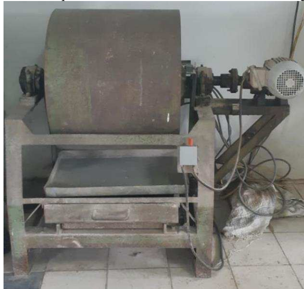
Figura 35 - Máquina utilizada no ensaio de abrasão "Los Angeles"
