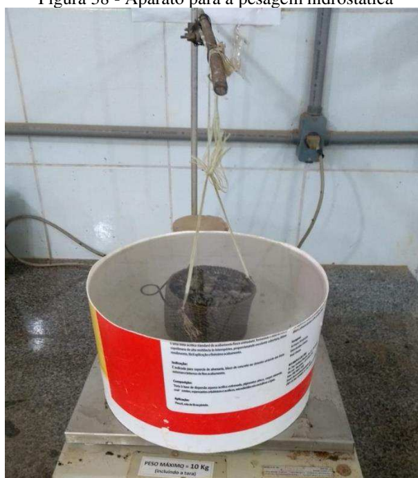
Figura 38 - Aparato para a pesagem hidrostática
