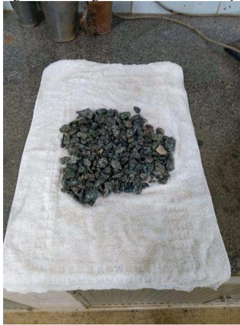
Figura 37 - Secagem da amostra de absorção
