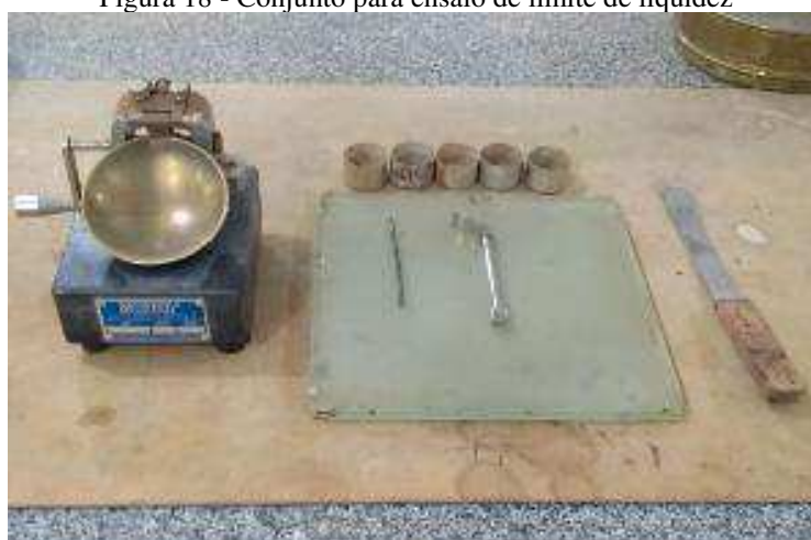
Figura 18 - Conjunto para ensaio de limite de liquidez
