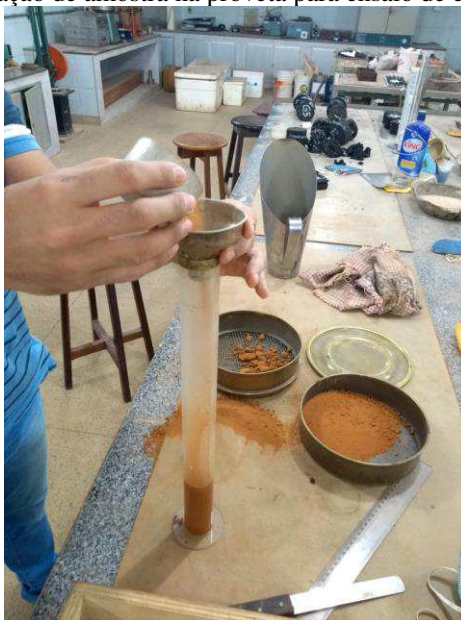
Figura 25 - Colocação de amostra na proveta para ensaio de equivalente de areia
