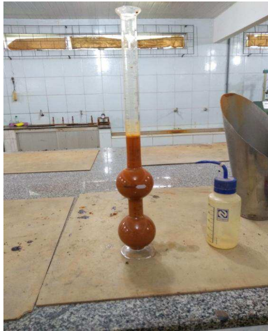
Figura 30: Frasco de Chapman com areia e água destilada
