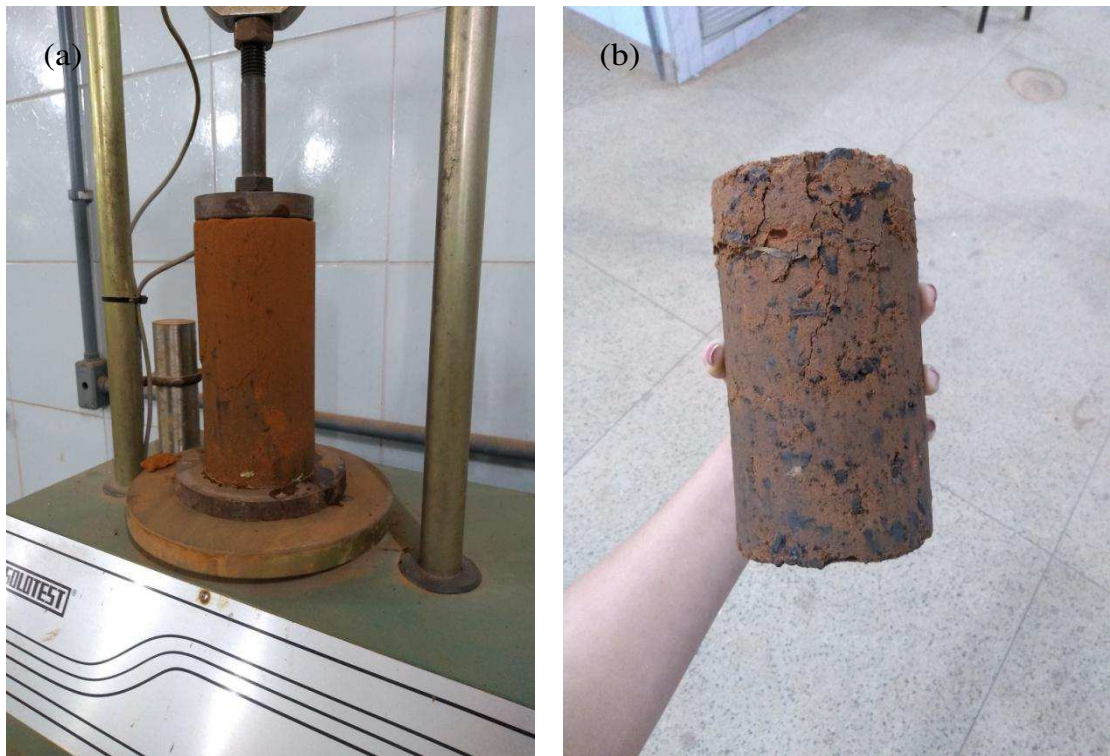
Figura 46: (a) Corpo de prova na máquina de ruptura e (b) aparência de um dos corpos após o rompimento
