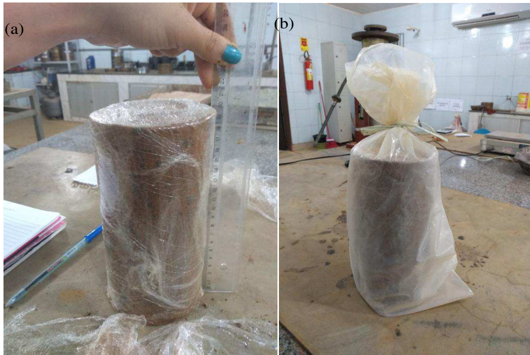
Figura 42: (a) Corpo de prova envolto com papel filme e (b) já envolto com o saco plástico
