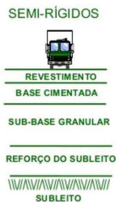
Figura 2: Seção de um pavimento semi-rígido
