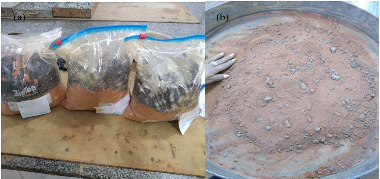
Figura 40: (a) Misturas separadas para o ensaio e (b) mistura na bandeja pronta para ser umidificada
