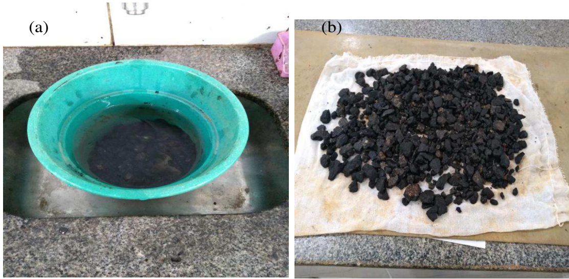
Figura 31 : (a) Material submerso e (b) material no pano seco para ser absorvido o excesso de água
