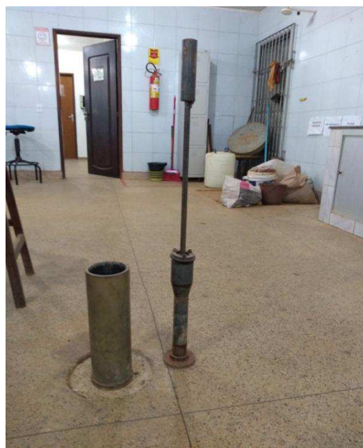
Figura 39: Molde e soquete utilizados no ensaio
