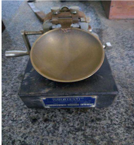
Figura 22: Aparelho de Casagrande
