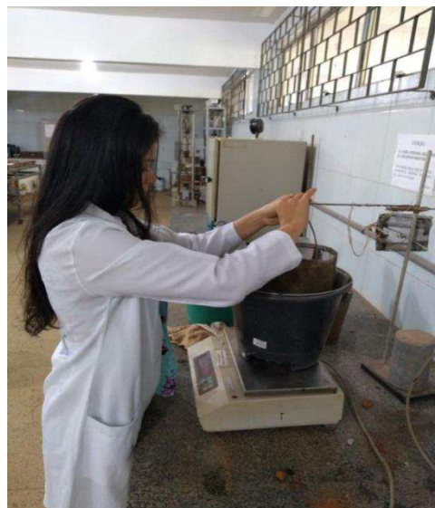
Figura 32: Realizando o ensaio de densidade do RAP
