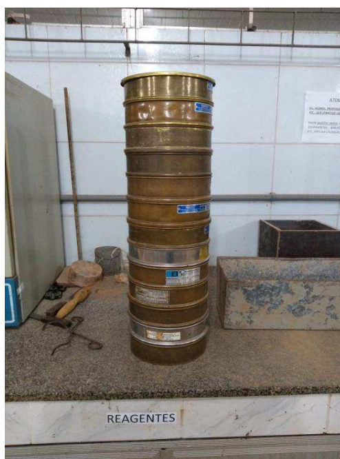
Figura 19: Jogo de peneiras para realizar o ensaio de granulometria
