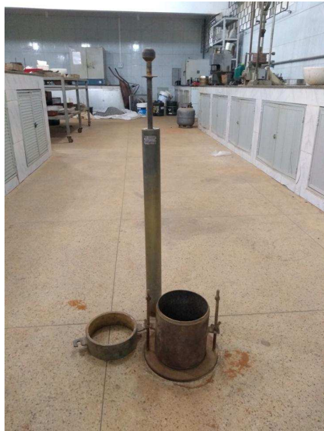
Figura 36: Cilindro e soquete utilizados no ensaio
