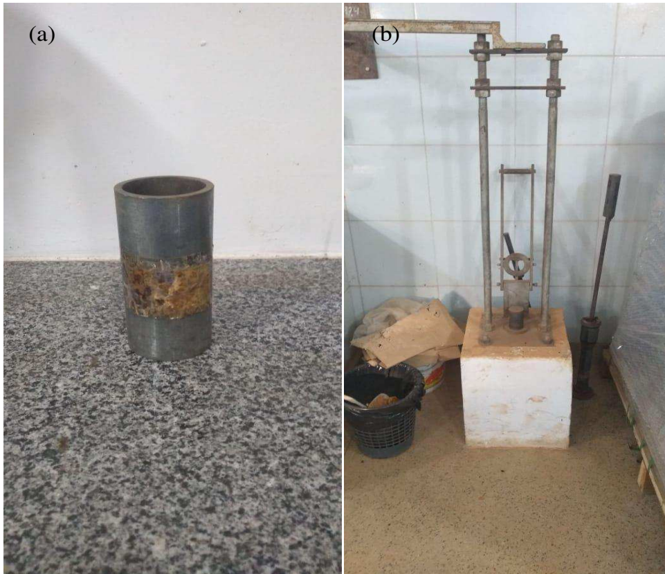
Figura 23: (a) Cilindro do ensaio MCT (b) compactador
