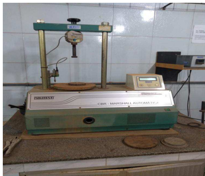
Figura 45: Máquina utilizada para o rompimento
