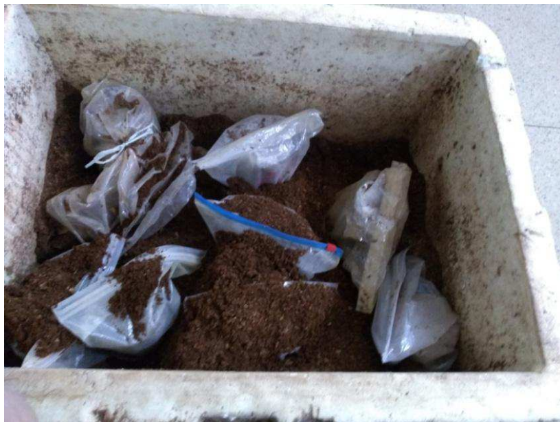
Figura 43: Corpos de prova na câmara úmida
