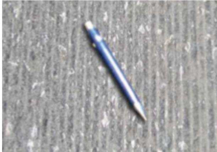
Figura 8: Superfície resultante da fresagem fina
