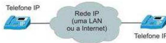
Figura 4: Ligação VoIP entre telefones IP.
