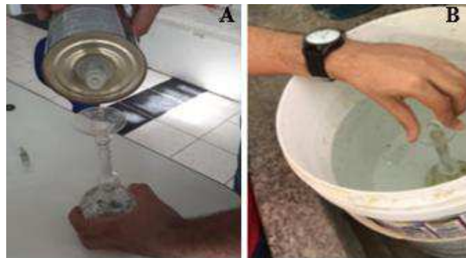
Figura 32 – Adição do querosene no frasco. (A): querosene sendo inserido no frasco (B): banho termorregulador.
