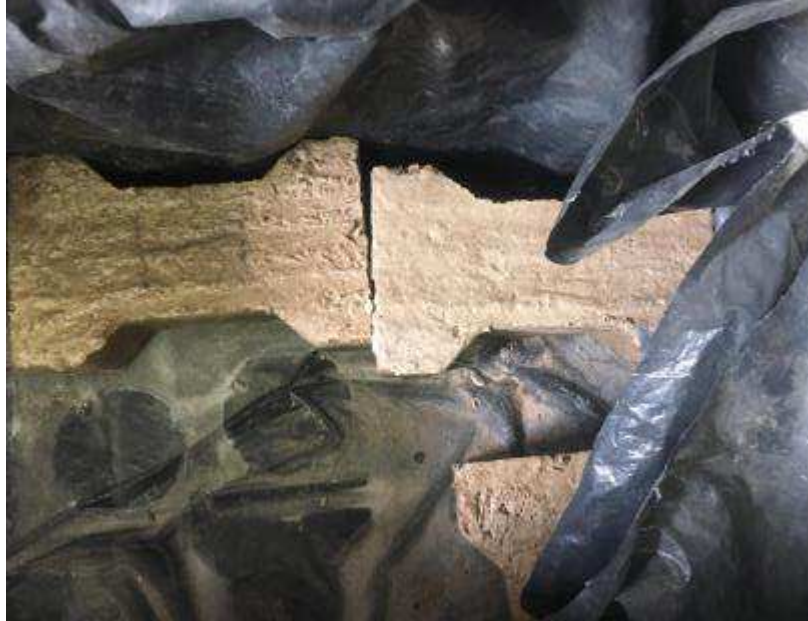
Figura 49 - Blocos adicionados a caixa de isopor junto com uma lona para proteção.
