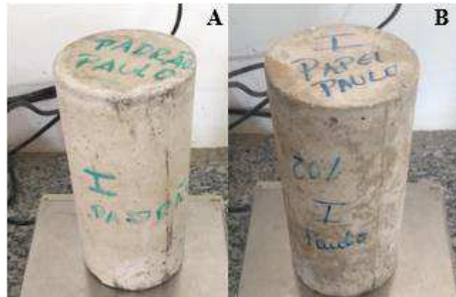
Figura 27 - Corpos de prova cilíndrico com traço 1:2:3:0,6. (A): corpo de prova com concreto padrão (B): corpo de prova com concreto adicionado de papel.
