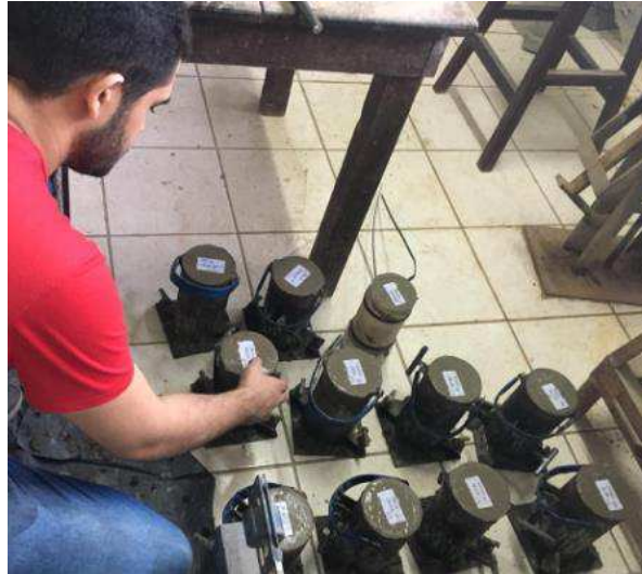
Figura 28 - Corpos de prova de traço 1:2:3:0,45 já moldados.
