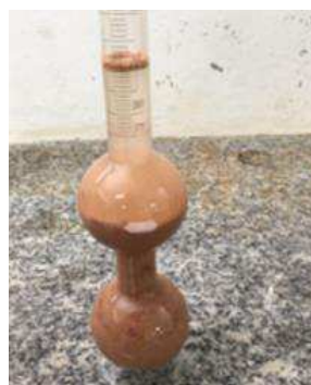
Figura 31 - Leitura final no frasco (conjunto agregado/água).
