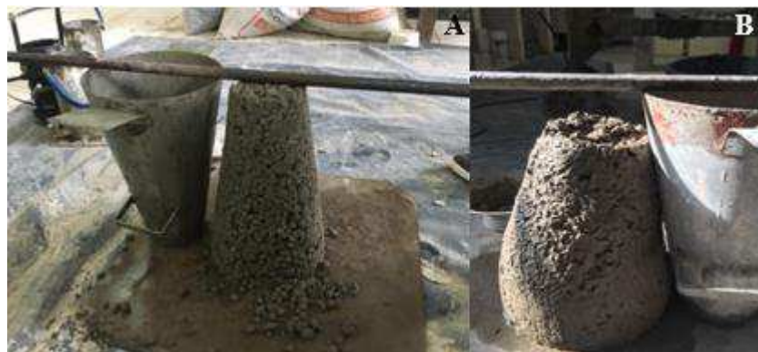
Figura 60 - Ensaio de Slump Test. (A): abatimento do concreto adicionado de papel (B): abatimento do concreto padrão.
