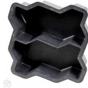
Figura 16 - Exemplo de forma que é vibrada na mesa.
