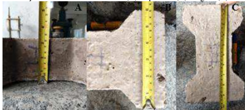
Figura 50 - Medição da dimensão dos blocos. (A): espessura (B): largura (C): comprimento.
