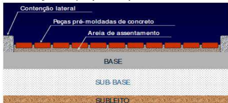
Figura 6 - Seção típica de um pavimento intertravado.
