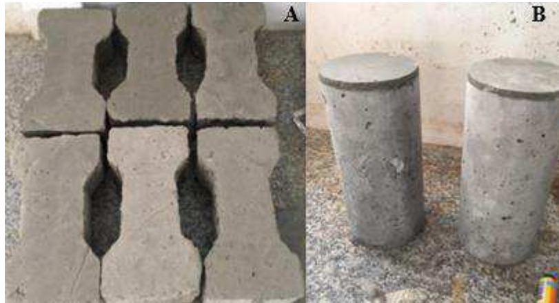
Figura 52 – Materiais capeados. (A): blocos intertravados capeados (B): corpos de prova cilíndricos capeados.
