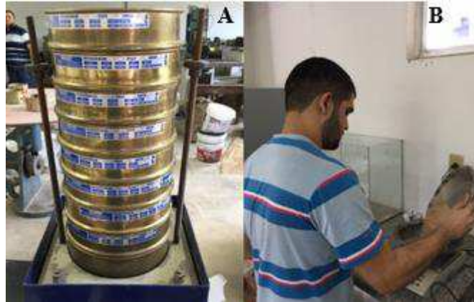
Figura 41 – Ensaio de granulometria da brita. (A): disposição das peneiras no agitador mecânico (B): agregado graúdo sendo pesado.
