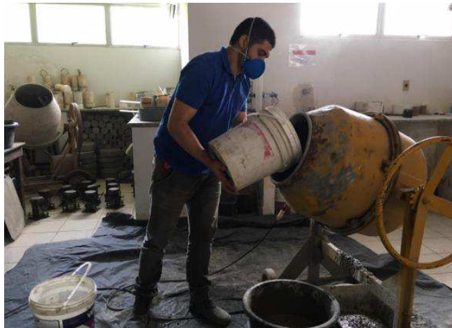
Figura 45 - Agregados sendo levados à betoneira.
