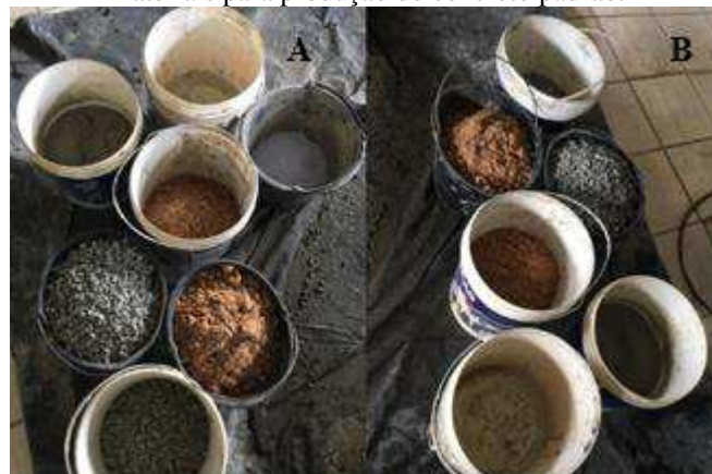
Figura 44 – Materiais prontos para serem misturados. (A): materiais para produção do concreto com papel (B): materiais para produção do concreto padrão.
