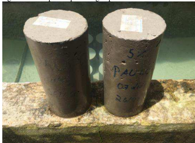
Figura 58 - Corpos de prova logo após serem retirados da estufa.
