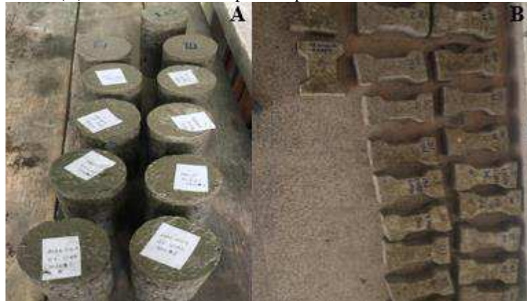
Figura 48 – Materiais logo após a desmoldagem.(A): corpos de prova cilíndricos prontos para serem adicionados a câmara úmida (B): blocos de concreto prontos para serem adicionados na câmara úmida.
