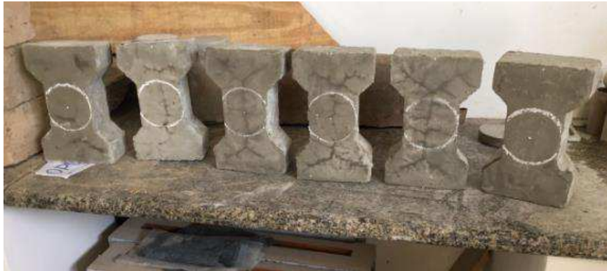
Figura 55 - Blocos de concreto com a marcação da posição das placas auxiliadoras.
