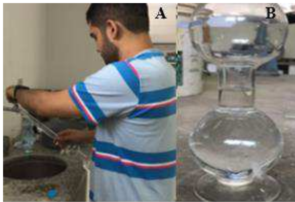
Figura 30 – Adição de água no frasco. (A): aluno inserindo água no frasco (B): frasco com água na marca de 200\text{ cm}^3 .
