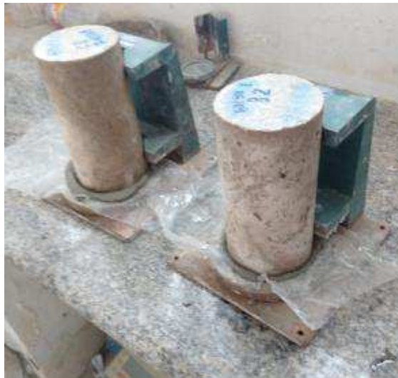
Figura 51 - Corpos de prova sendo capeados com o Capeador.
