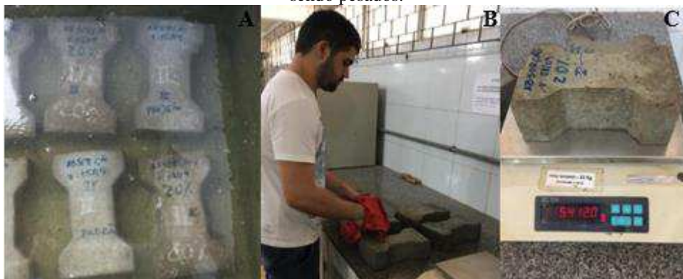
Figura 59 – Ensaio de absorção dos blocos. (A): blocos imersos em água (B): blocos sendo enxutos (C): blocos sendo pesados.
