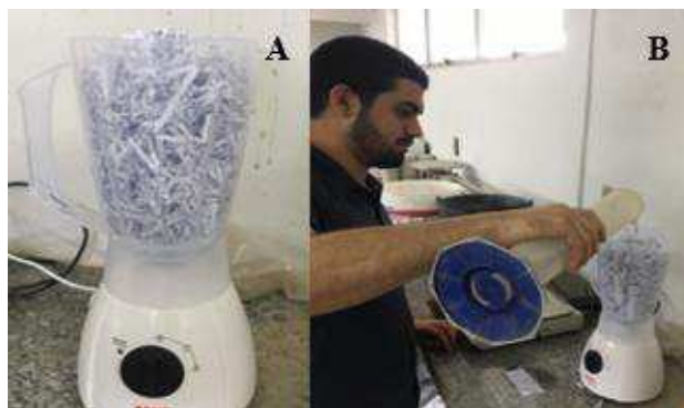
Figura 24 – Processo de trituração do papel. (A): papel em tiras no liquidificador (B): aluno adicionando água para posterior trituração.
