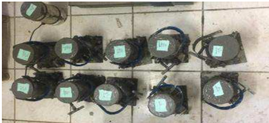
Figura 47 - Concreto já adicionado nos moldes metálicos.
