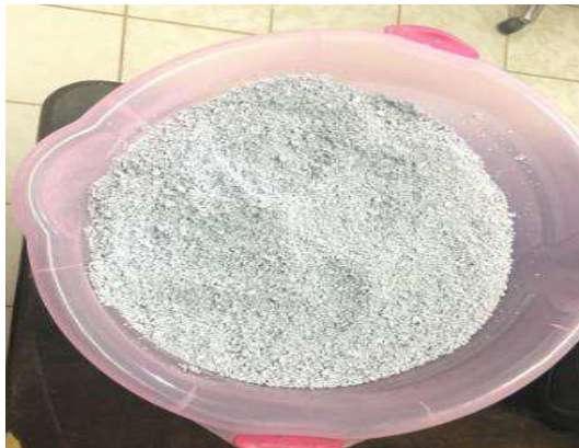
Figura 26 - Papel em formato de pelotas pronto para ser adicionado ao concreto.
