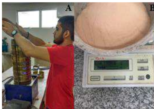
Figura 40 – Ensaio de granulometria da areia. (A): adição do agregado miúdo no conjunto de peneiras (B): agregado sendo pesado.
