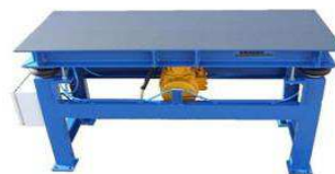
Figura 15 - Exemplo de mesa vibratória utilizada na fabricação de peças viradas.
