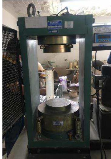
Figura 54 - Corpo de prova prestes a sobre compressão axial na máquina de compressão.
