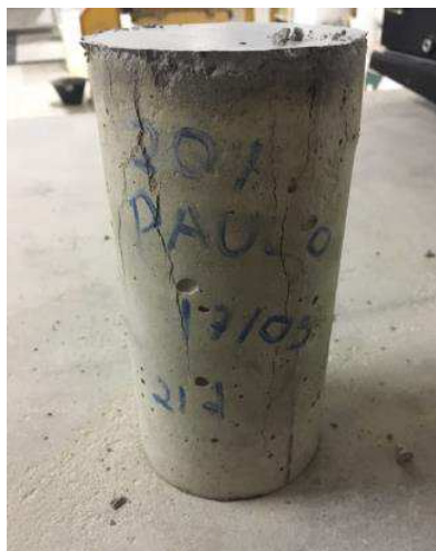
Figura 63 - Exemplo de ruptura cisalhada.
