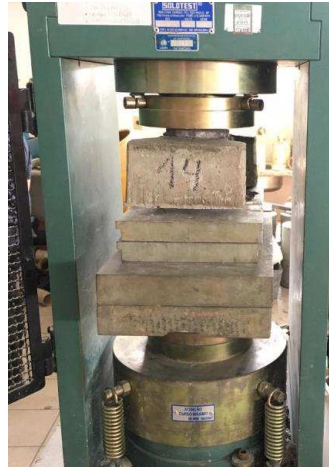
Figura 56 - Rompimento do bloco de concreto para pavimentação intertravada.
