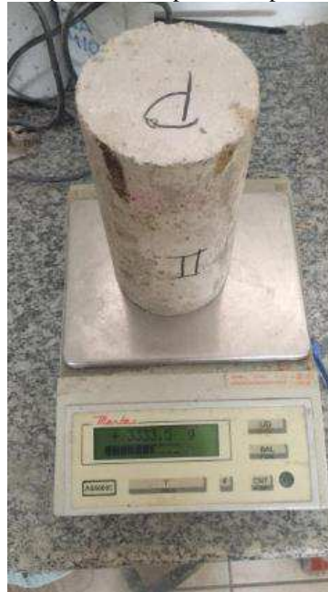
Figura 57 - Corpo de prova sendo pesado depois de 72 hrs na estufa.
