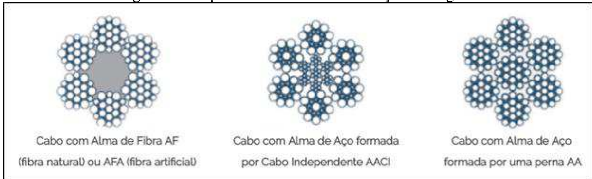
Figura 29 - Tipo de alma de um cabo de aço de uso geral
