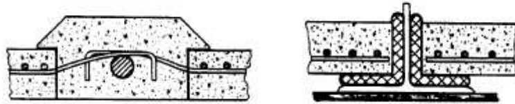
Figura 38 – Fixação das placas de argamassa ou de concreto armado
