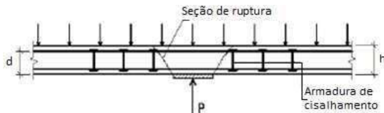
Figura 24 – Ruptura adjacente ao pilar
