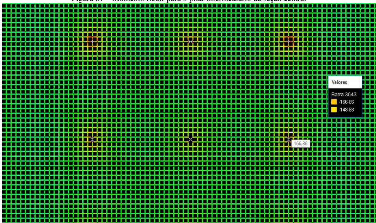
Figura 67 – Momento fletor para o pilar intermediário da seção central
