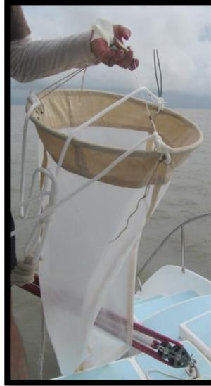
*Figura 10 - Rede cilindro cônica, utilizada na obtenção dos dados biológicos.*
