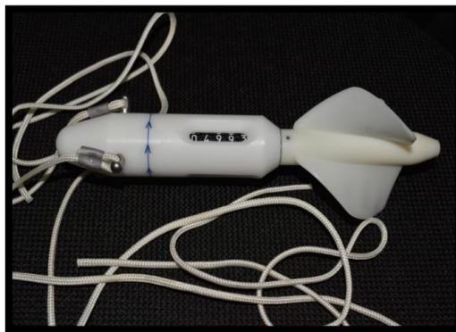
*Figura 11 - Fluxômetro para acoplar a rede de Ictioplâncton.*
