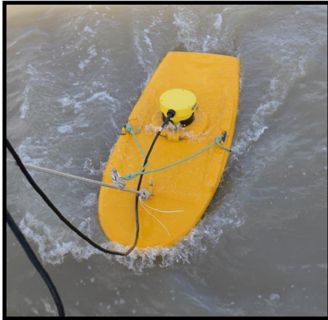
*Figura 6 - ADCP Sontek utilizado na coleta dos dados.*
