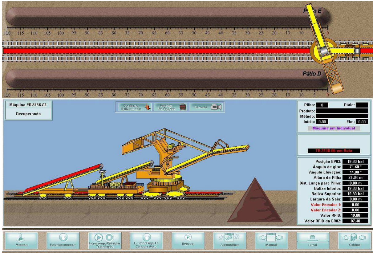
Figura 5 - Janela de supervisão e controle Empilhadeira
