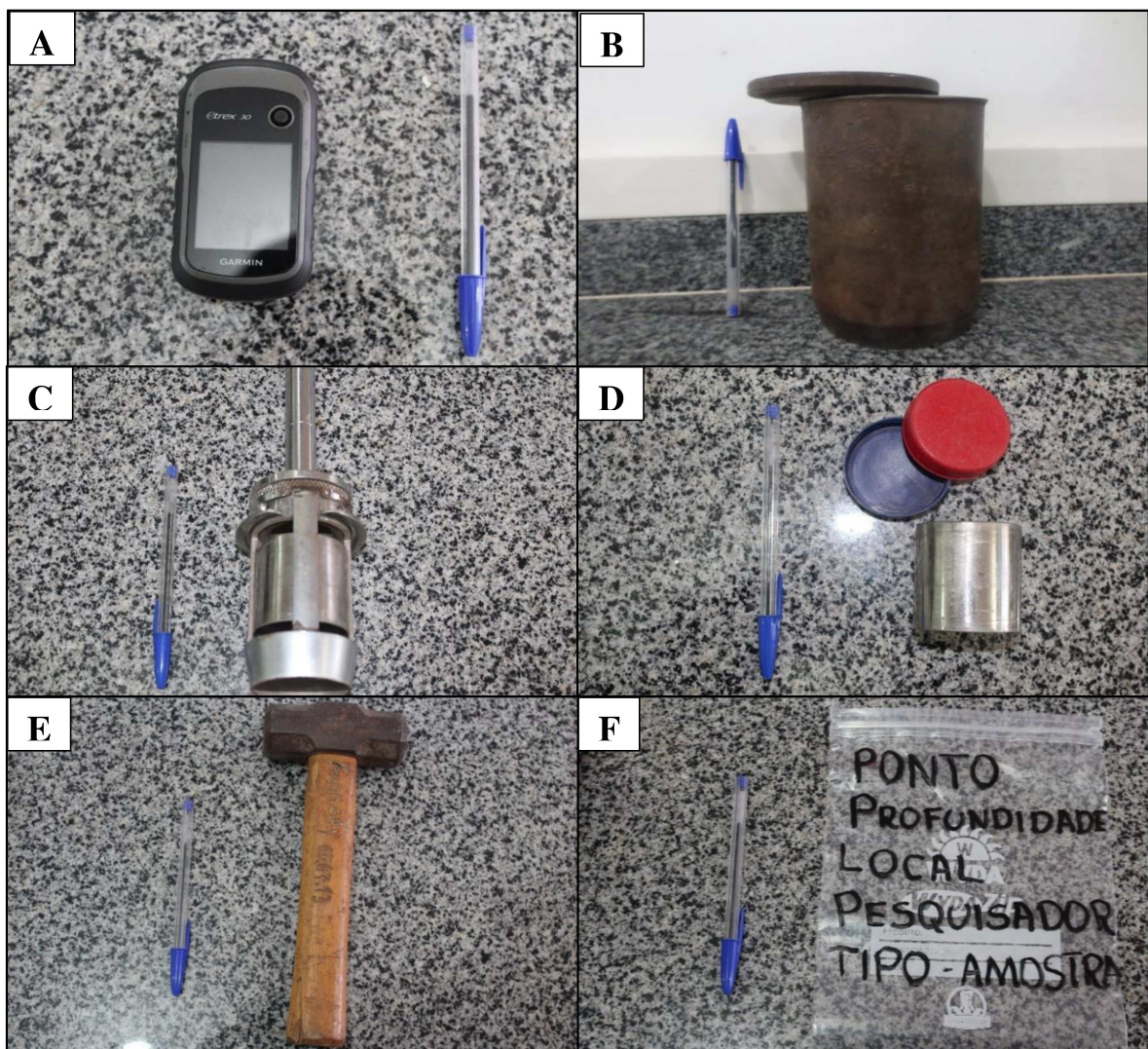
Figura 9 - Equipamentos e ferramentas utilizadas em campo: A – GPS; B – Infiltrômetro; C – Trado volumétrico; D – Anel volumétrico; E – Martetele; e F – Saco hermético
