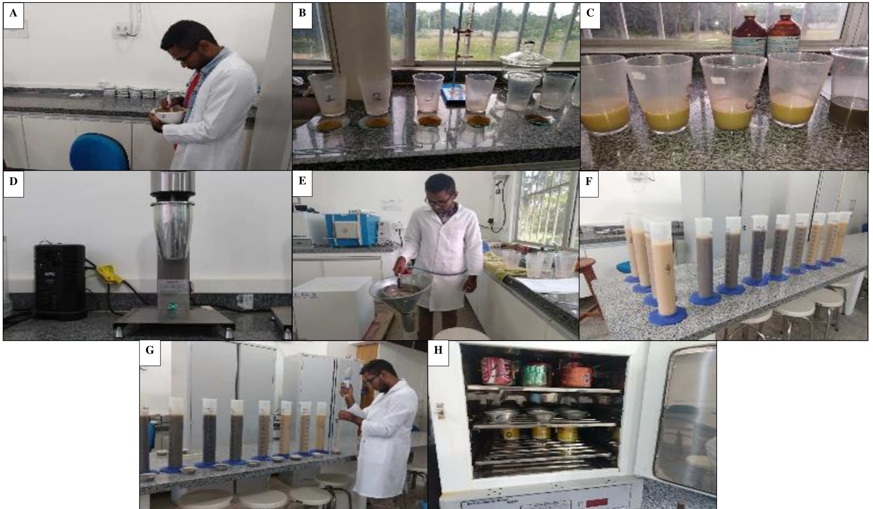
Figura 19 - Procedimentos para análise granulométrica: A – Destorroamento das amostras; B – “Ataque” das amostras; C – Adição de solução de NaOH 1N as amostras; D – Amostras agitadas com o stirrer ; E – Peneiramento com jatos d’água; F – Repouso das amostras anteriormente agitadas; G – Coleta do material em suspensão na proveta; e H – Armazenamento das alíquotas na estufa
