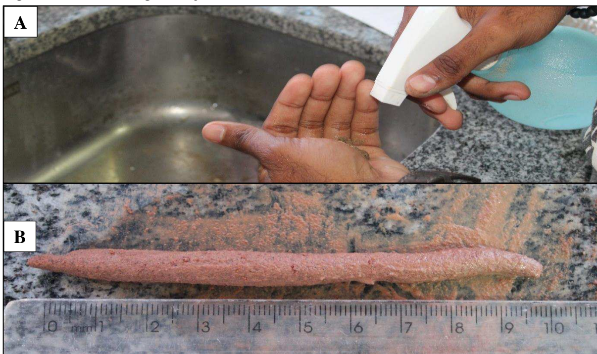
Figura 15 - A – Homogeneização da amostra; B – Formando cilindro
