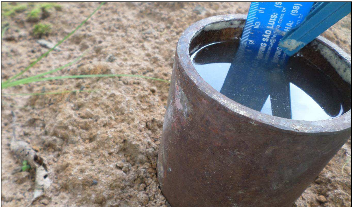
Figura 12 - Ensaio do teste de infiltração
