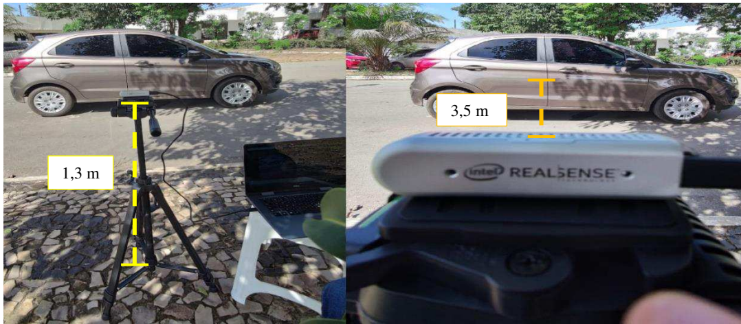
Figura 17. Demonstração do posicionamento da câmera no campus Paulo VI – UEMA. À direita, distância da câmera em relação ao carro e, à esquerda, em relação ao chão.
