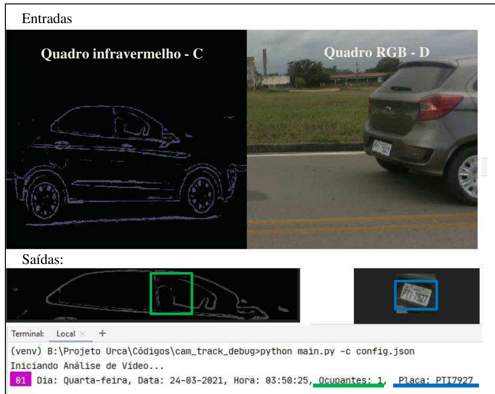
Figura 23. Resultados do algoritmo de capturas para os pontos C (infravermelho) e D (RGB)
