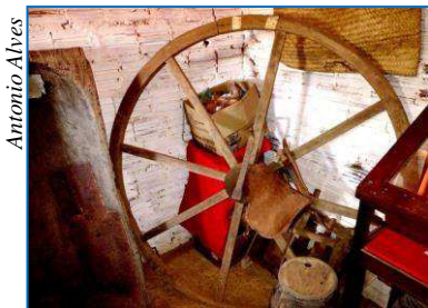
Imagem 18 - Roda de madeira movida manualmente para girar uma bola de serrar mandioca.
