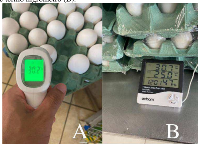
Figura 2 – Aferições realizadas nos estabelecimentos utilizando termômetro infravermelho (A) e termo higrômetro (B).
