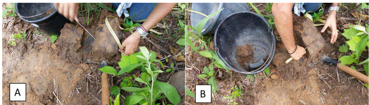
Figura 4. Medição das camadas de 0-5, 5-10 e 10-20 cm de profundidade do solo coletado com uma pá de corte na área experimental (A); Corte e retirada das camadas de solo separadamente, para compor a amostra composta (B).
