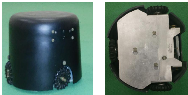
Figura 23. Robô móvel Scisoccer Xbot
