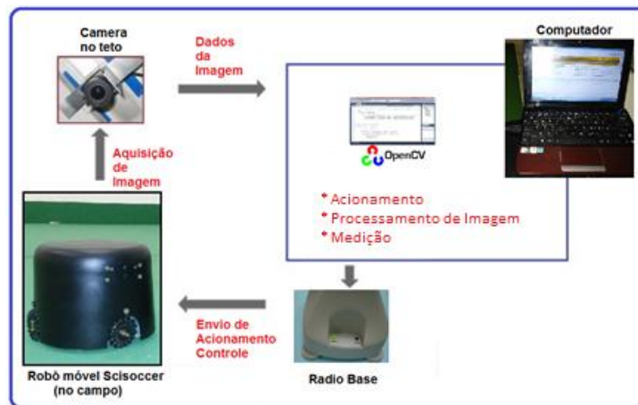
Figura 45. Estrutura geral do sistema
