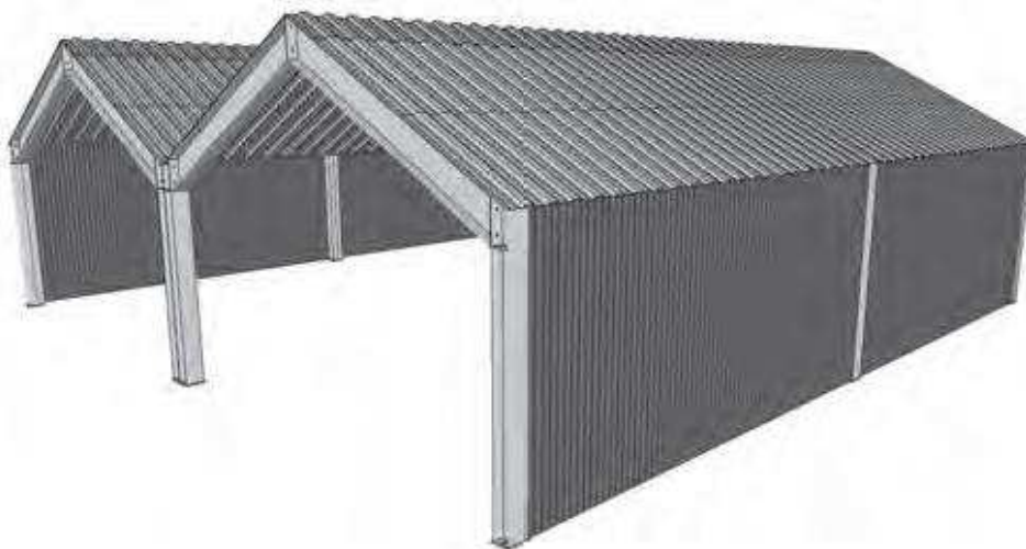
Figura 4.6: Geminado com quatro águas (adaptado de PRAVIA ET AL, 2010),
