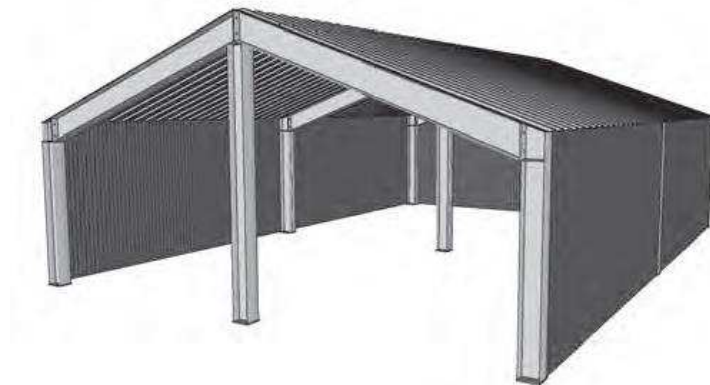
Figura 4.7: Geminado com duas águas e coluna intermediária (adaptado de PRAVIA ET AL, 2010).
