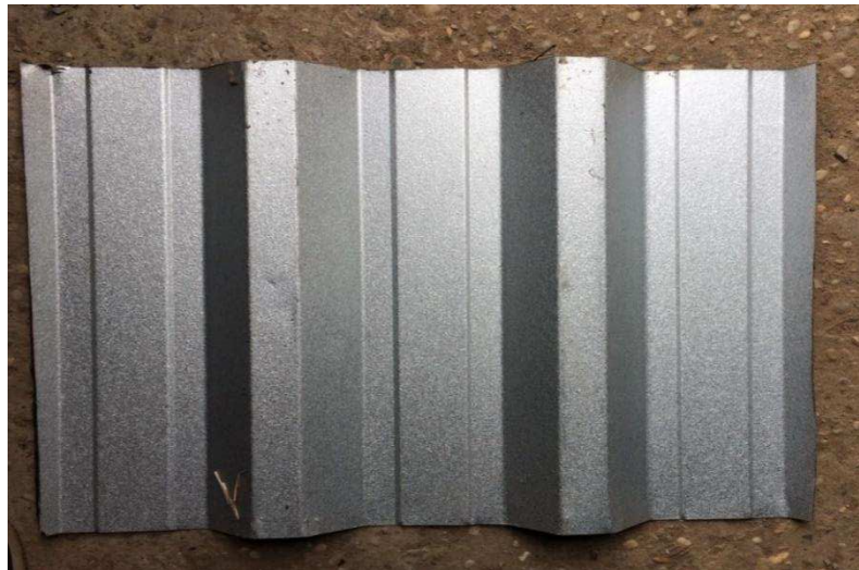
Figura 4.10: Telha aço galvanizado usado na cobertura do galpão estudado.
