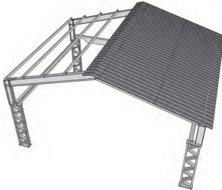
Figura 4.5: Edifício industrial com coluna treliçada para receber a coluna da cobertura e o apoio da viga de rolamento de ponte rolante (adaptado de PRAVIA ET AL, 2010).
