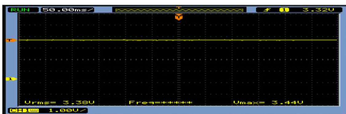
Figura 4.12. Sinal de piezoelétricos retificado com LTC-3588 (Ferreira, 2017)
