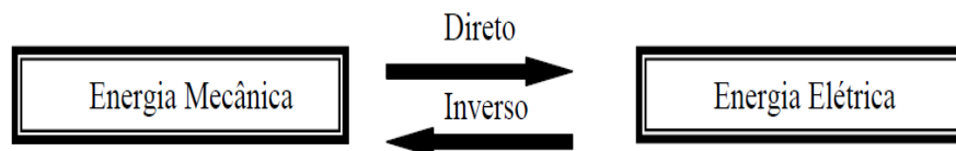
Figura 2.6. Representação esquemática da conversão de energia no efeito piezoelétrico (Wang, 2002)
