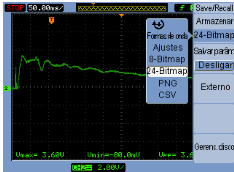
Figura 4.9. Sinal de resposta de uma pastilha piezoelétrica com circuito retificador visualizado através de osciloscópio
