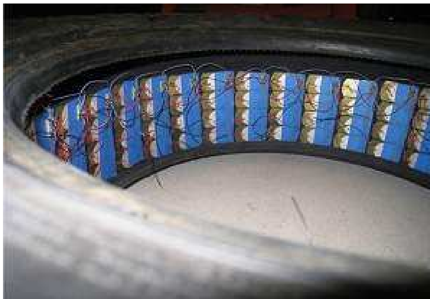
Figura 2.9. Malha piezoelétrica de nanogeradores dentro do pneu (Makki e Pop-Iliev, 2011)
