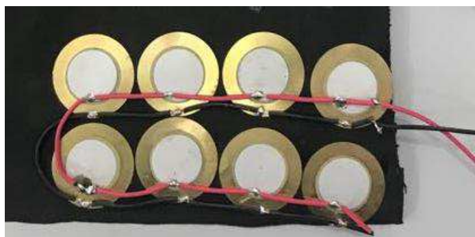
Figura 3.13. Circuito com 8 pastilhas ligadas em paralelo
