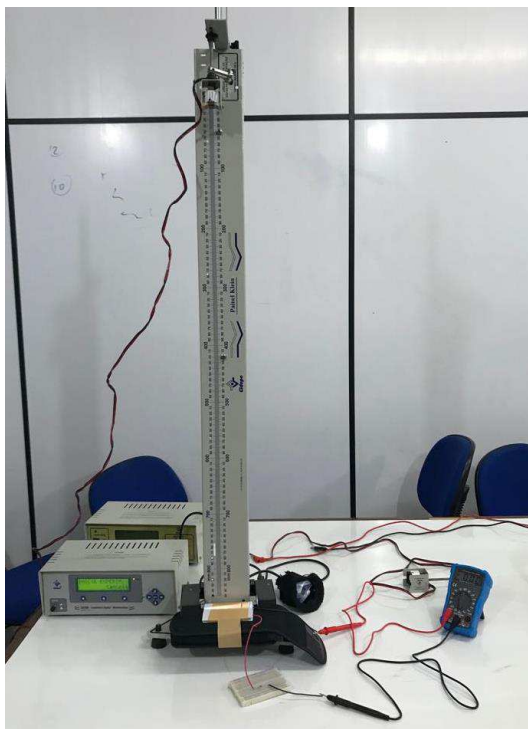
Figura 3.10. Aparelho para estudo de queda livre com anteparo e eletroímã
