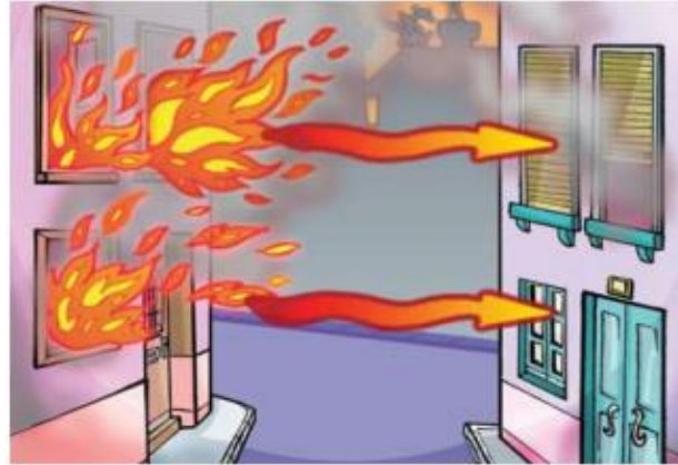
Figura 4 - Fenômeno de radiação em um ambiente edificado
