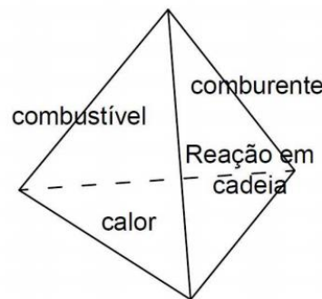
Figura 1 - Ilustração do triângulo do fogo e tetraedro do fogo
