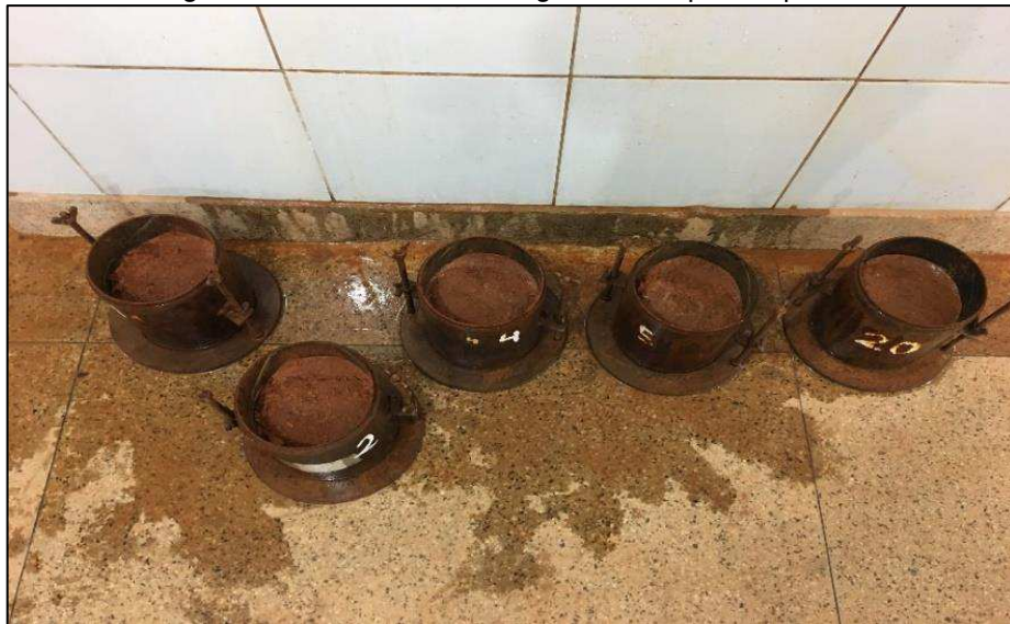
Figura 34 - Escoamento da água dos corpos de prova.
