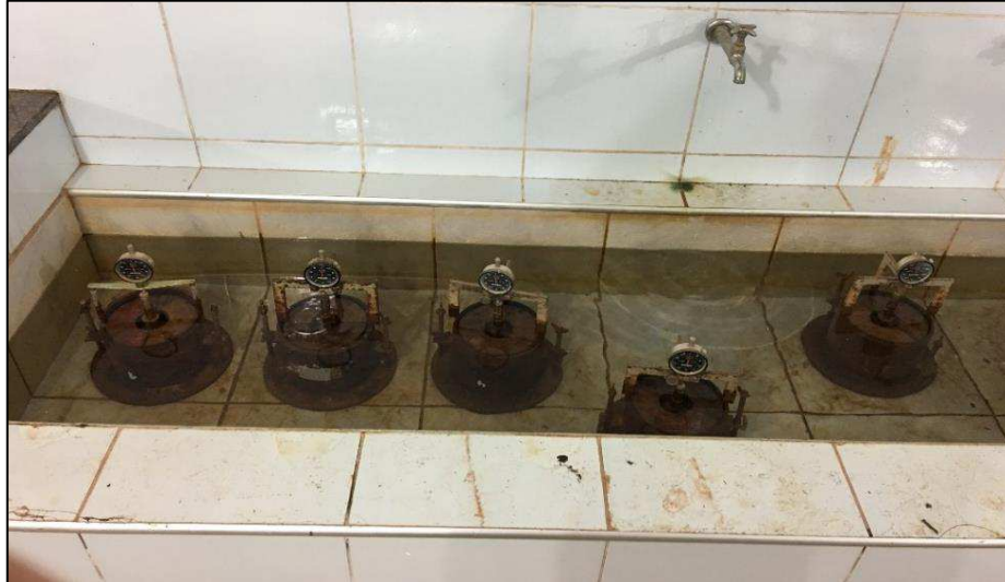
Figura 33 - Corpos de prova submetidos à imersão no tanque.
