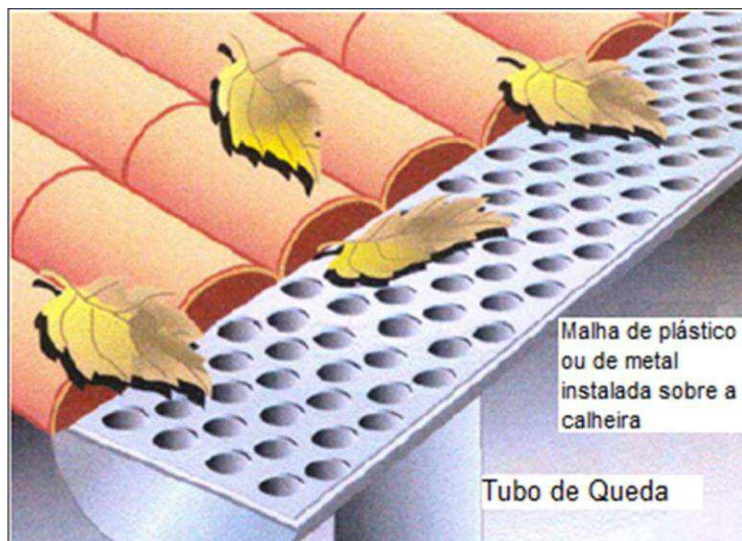
Figura 5 – Sistema de grade localizada sobre grelha
