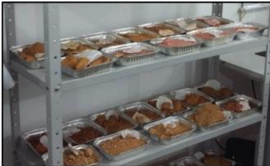
Foto 10 - Amostras de solos- processo de secagem
