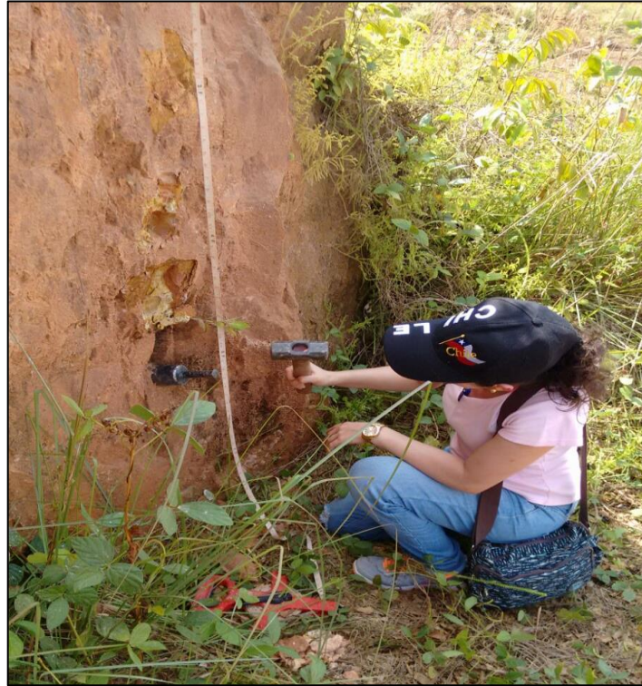
Foto 4 - Coleta de amostras de solo indeformado da área de mineração
