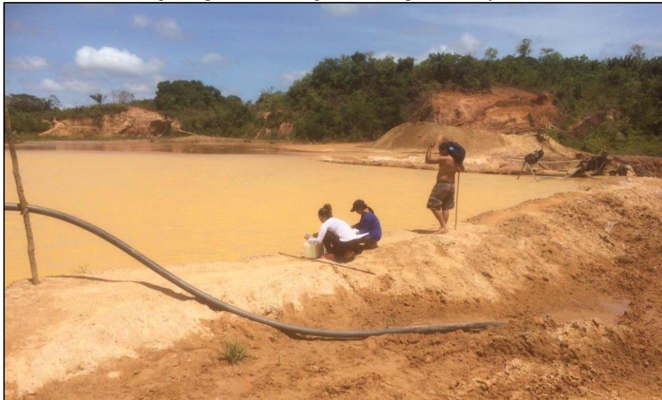
Foto 6 - Coleta de água superficial em lago formado por mineração
