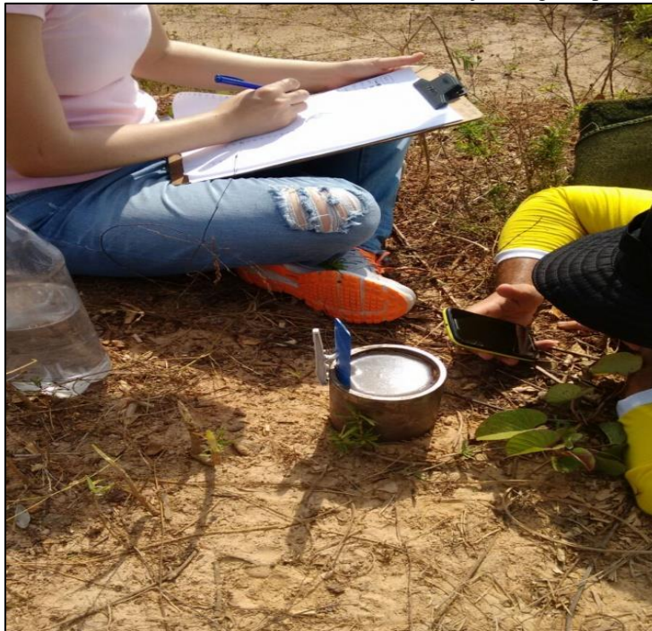
Foto 5 - Teste de infiltrômetro na área de mineração do garimpo de Caxias
