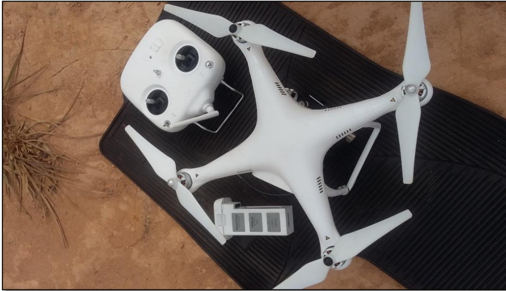
Foto 1- Dronne utilizado para sobrevôo na área minerada e captura de imagens aéreas
