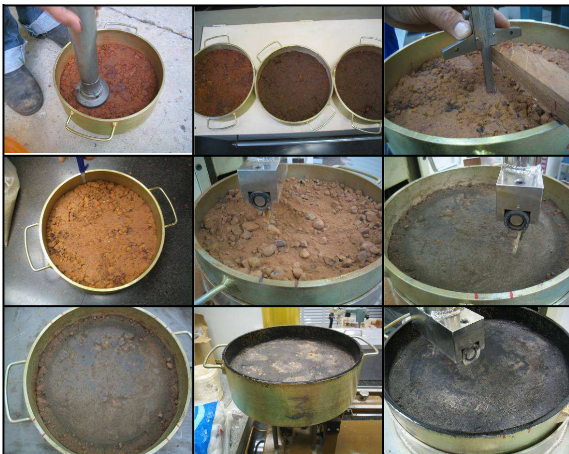
Figura 5.38 – Ensaio WTAT sobre amostra de solo 424 sem emulsão; com 4,5% de emulsão; com 4,5% de emulsão + capa selante
