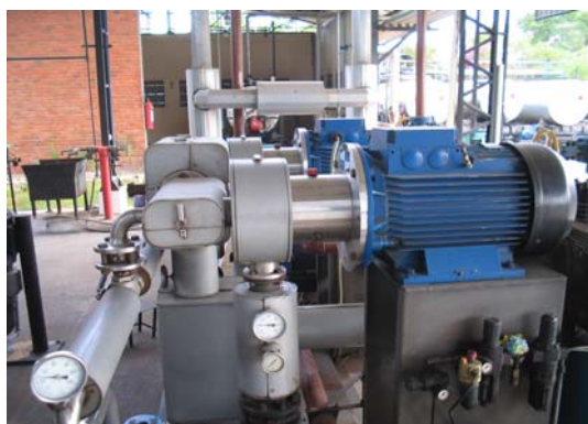
Figura 3.4 – Moinho coloidal (esquerda) e detalhe do rotor (direita)
