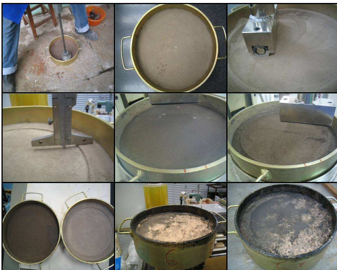
Figura 5.39 – Ensaio WTAT sobre amostra de solo 424 sem emulsão; com 4,5% de emulsão; com 4,5% de emulsão + capa selante
