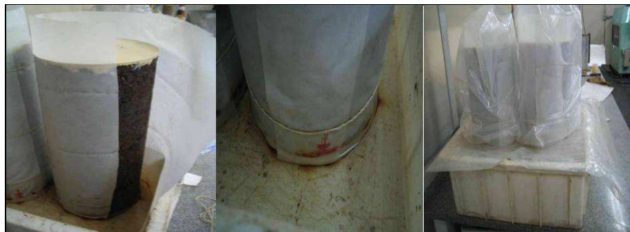
Figura 6.1 - Preparação dos corpos-de-prova com papel filtro para frente úmida
