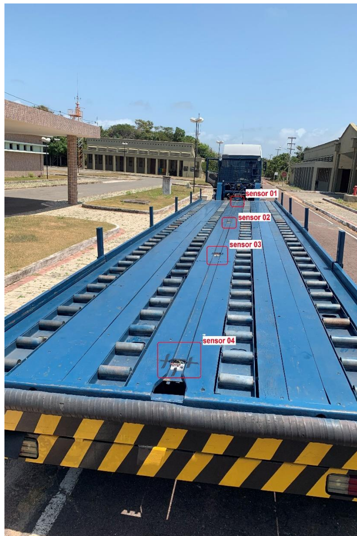
Figura 27: Instalação dos sensores.
