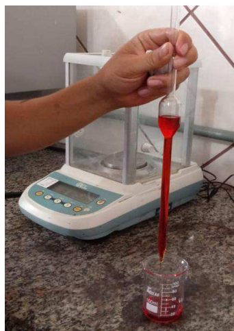
Figura 3.4 - Definição da densidade com o uso de balança, pipeta e Becker.
