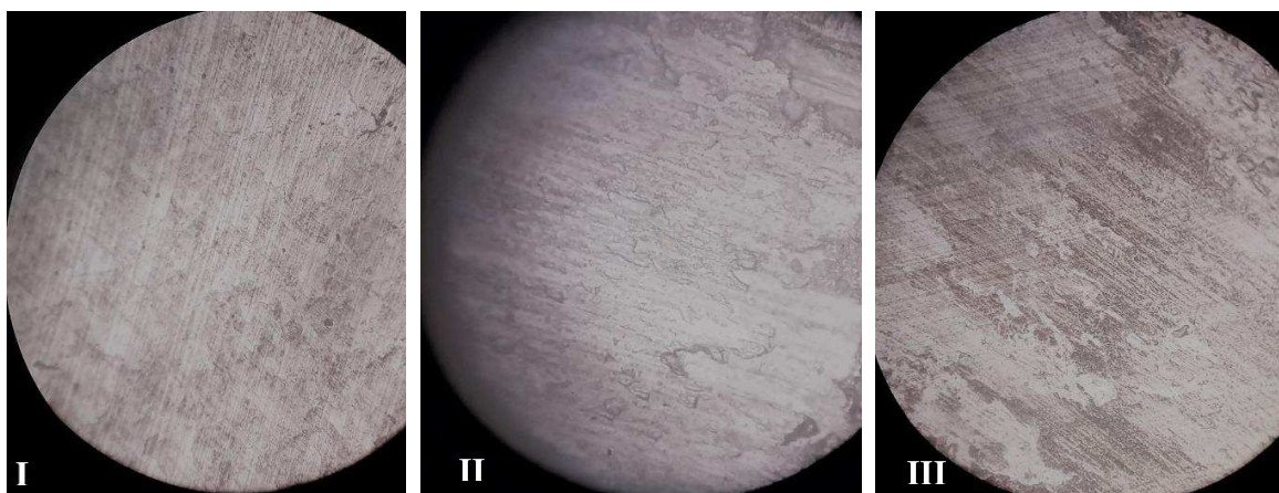
Figura 4.7 - Fotos microscópica de 500x após os ensaios nos corpos I, II e III respectivamente ensaiados com os óleos de urucum, Lubrax e coco.
