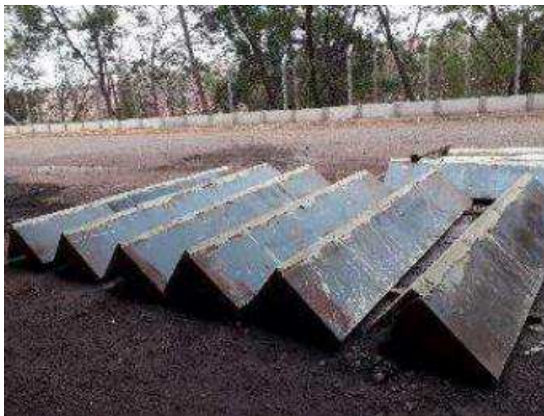
Figura 35 – Fabricação do console da caixa seca externa.
