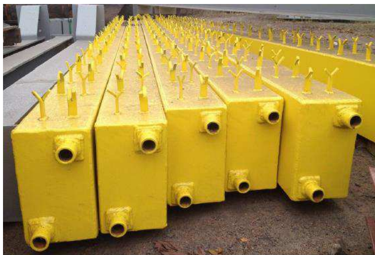
Figura 29 - Caixas d'água utilizadas no forno de grelha móvel
