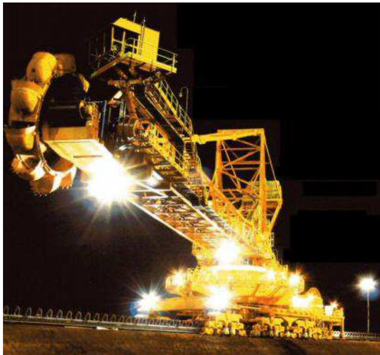
Figura 2.6 - Recuperadora de Finos.
