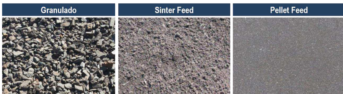
Figura 2.2 - Diferença visual entre o Minério Granulado, Sínter Feed e Pellet Feed.
