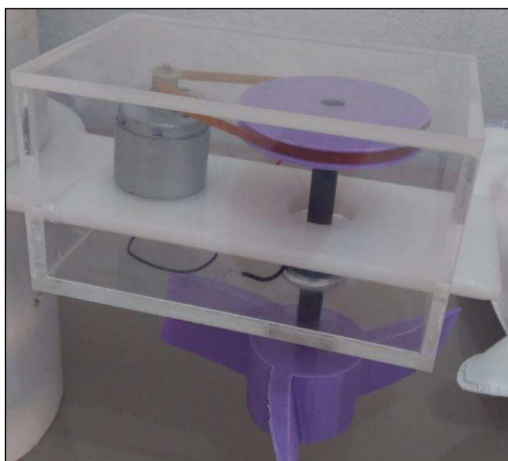
Figura 4.9 – Mecanismos utilizados na conversão da energia das correntes em eletricidade.
