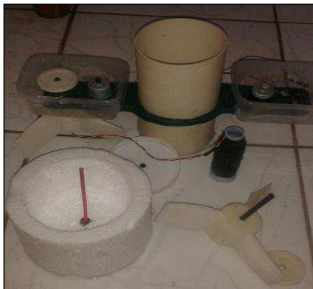
Figura 4.2 – Protótipo do projeto conversor de energia oceânica desmontado (Adaptado de Silva, 2016).
