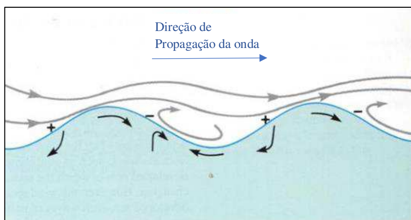
Figura 3.5 – Modelo de geração da onda oceânica (Adaptado de Park e Brown, 1999).
