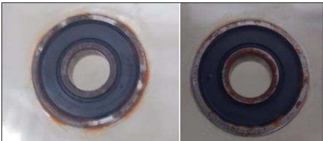
Figura 5.3 – Ataque de corrosão nos rolamentos.
