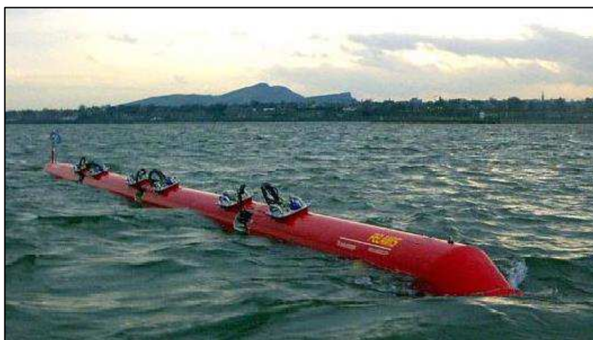
Figura 3.9 – Conversor de energia das ondas Pelamis offshore do tipo progressivo (Adaptado de Power Technology, 2018).
