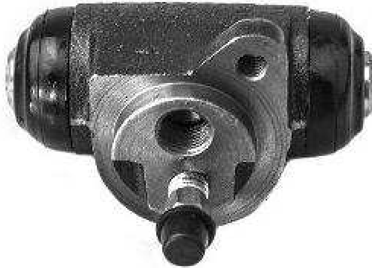
Figura 2.16-Cilindro auxiliar vw gol (Adaptado de MERCADO LIVRE, 2018)
