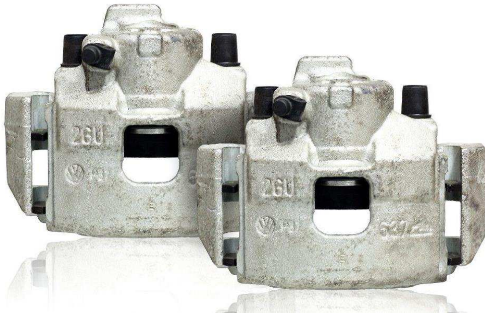
Figura 2.11-Par de pinças de freio e jogo de pastilhas do vw gol g4 (Adaptado de MERCADO LIVRE, 2017).
