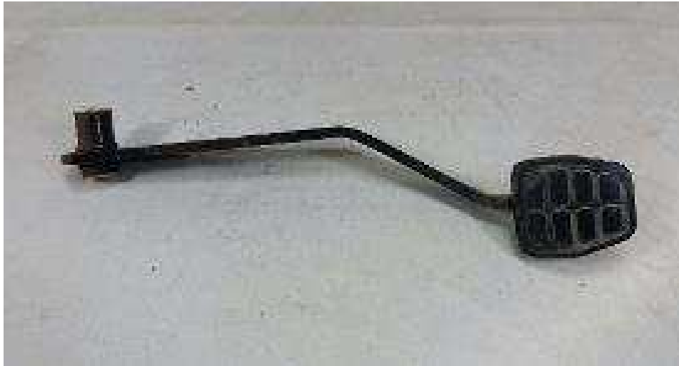
Figura 2.22-Pedal de freio original vw gol g4 (Adaptado de MERCADO LIVRE, 2018).
