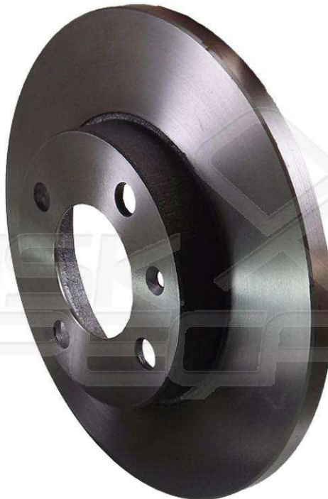
Figura 2.9-Disco de freio sólido do vw gol g4 (Adaptado de MDS, 2018).
