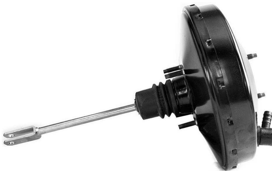
Figura 2.18-Hidrovácuo/servo-freio volkswagen gol g4 (Adaptado de AUTOPARTS, 2018).
