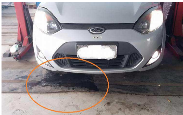
Figura 3.1 - Vazamento em um modelo Fiesta
