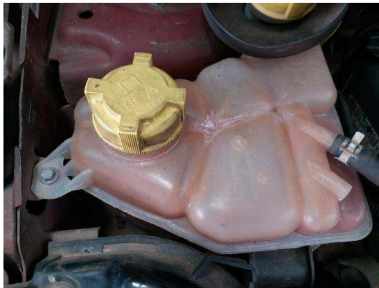
Figura 3.11 - Reservatório de água
