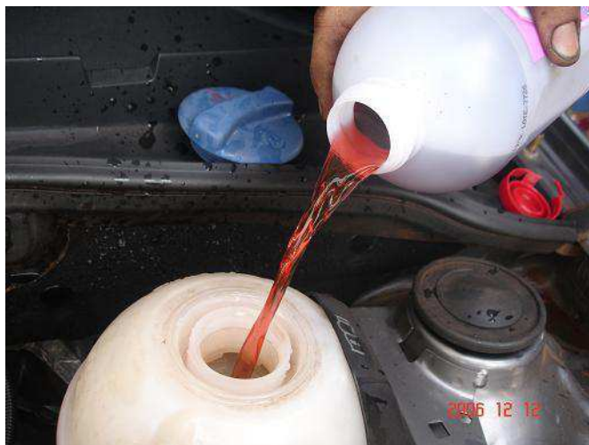
Figura 3.10 - Fluido de arrefecimento sendo repost
