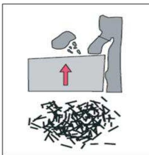
Figura 2.8: Cavaco de cisalhamento. (ADAPTADO DE STOETERAU, 2015).
