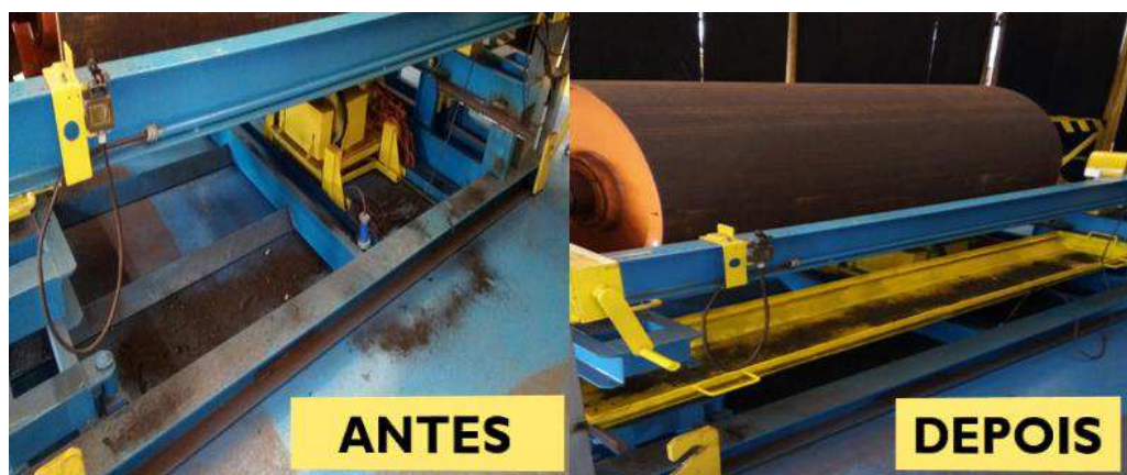
Figura 6-42 Comparação entre o antes e depois da utilização da bandeja de contenção de resíduos
