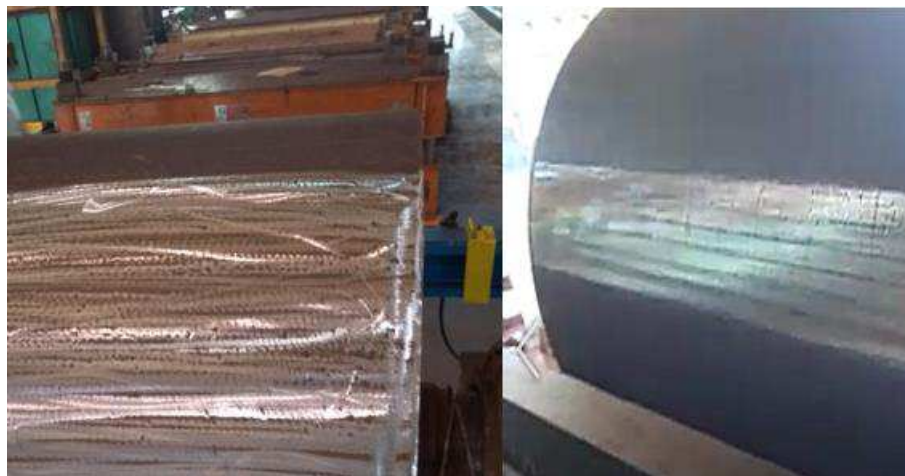
Figura 6-39 Comparação da qualidade do lixamento realizado manual (esquerda) e automaticamente (direita)
