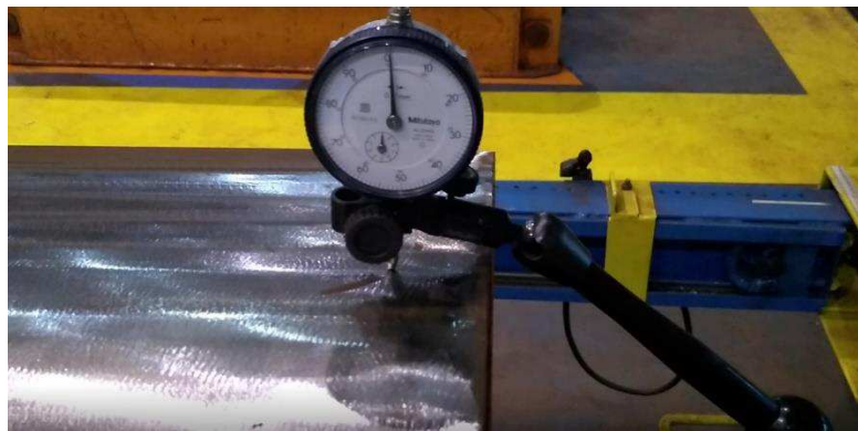
Figura 6-40 Utilização do relógio comparador para medir irregularidades na superfície lixada
