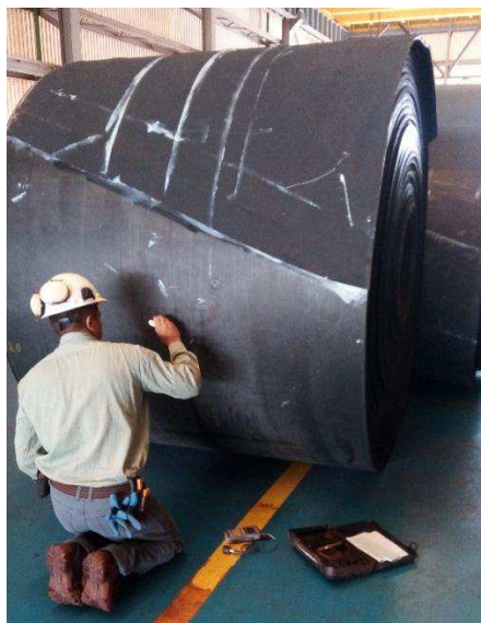
Figura 6-7 Medição de espessura de correia antes da utilização
