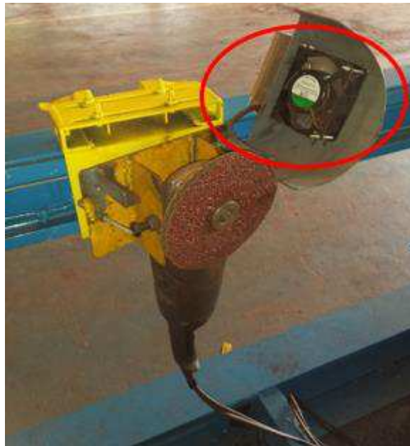
Figura 6-41 Utilização de cooler para resfriamento da esmerilhadeira
