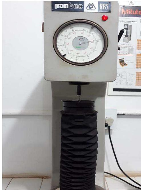
Figura 4.7 – Realização do ensaio de dureza Rockwell.
