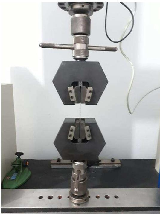
Figura 4.4 – Realização do ensaio de tração.
