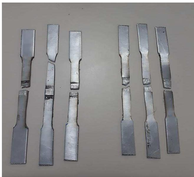
Figura 5.1 – Corpos de prova após o ensaio de tração; SMAW e GTAW respectivamente.
