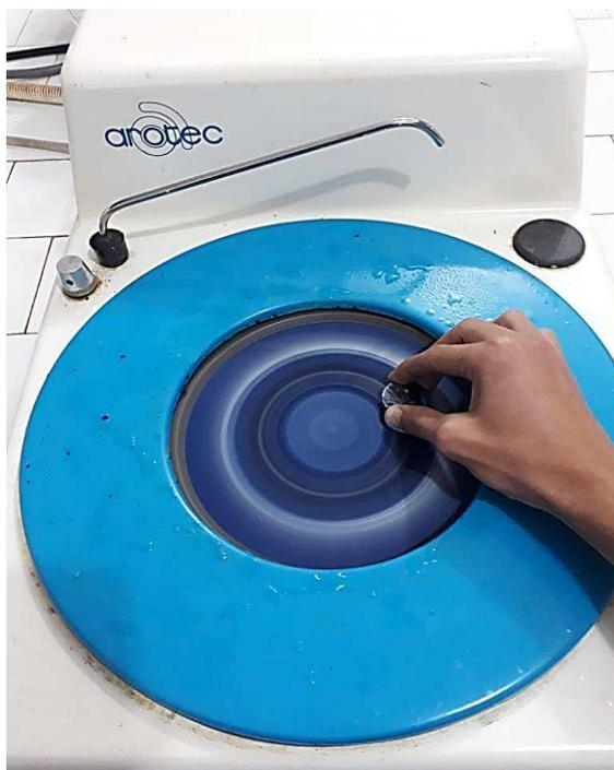
Figura 4.12 – Polimento sendo realizado na politriz Aropol 2V da Arotec.
