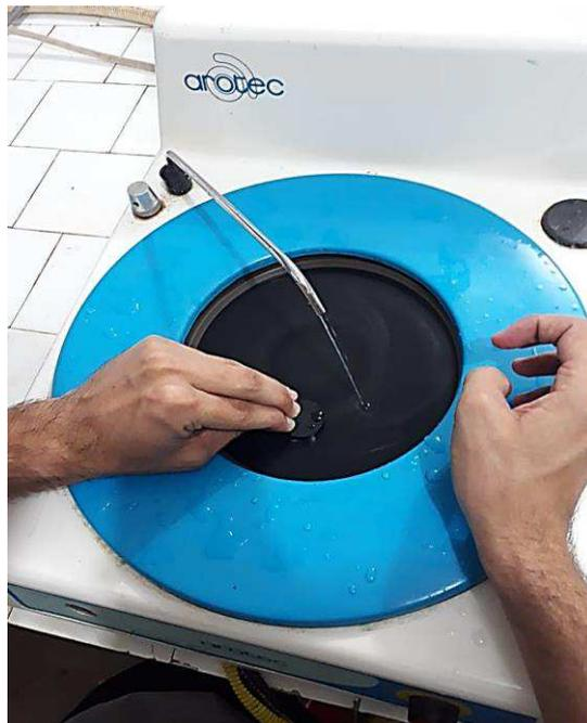
Figura 4.10 – Lixamento sendo realizado na lixadeira Aropol 2V da Arotec.
