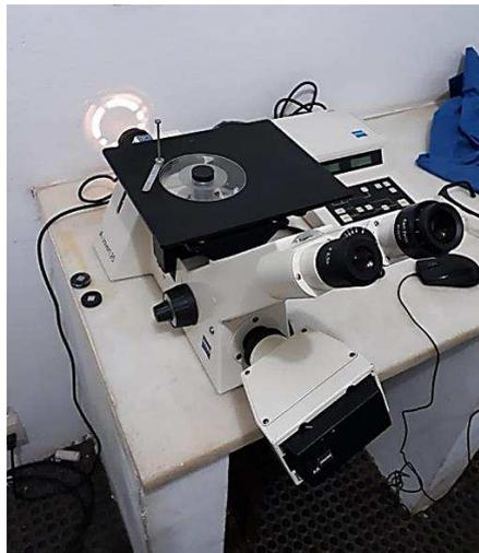
Figura 4.16 – Amostra sendo analisada no microscópio óptico.
