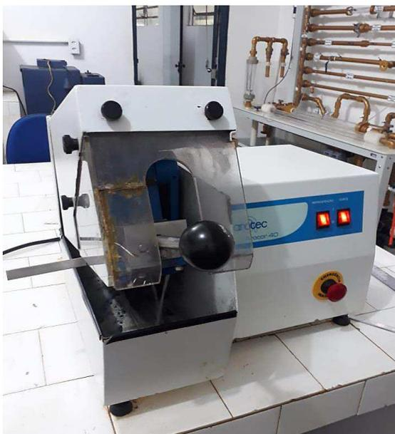
Figura 4.8 – Cortadora metalográfica Arocor 40 da Arotec.
