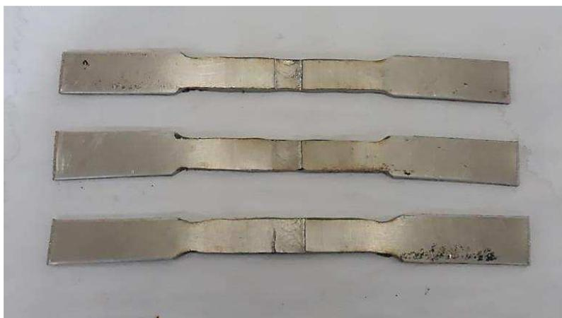
Figura 4.5 – Corpos de prova para o ensaio de tração.
