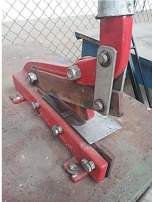
Figura 4.3 – Corte das amostras na tesoura guilhotina.
