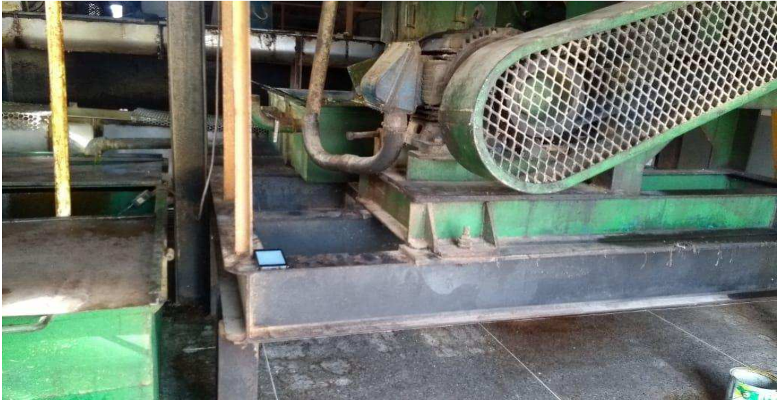
Figura 3.14 – Medições das vibrações na estrutura (Fonte: Autor).
