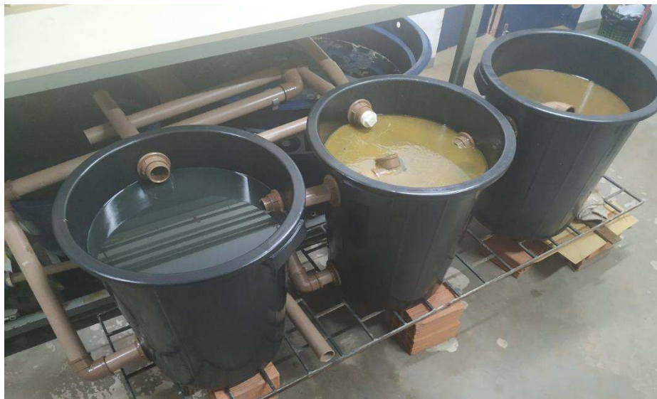
Figura 4-4: Tanques separadores da mistura água-óleo.
