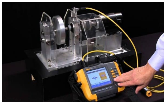
Figura 6.5 – Analisador de Vibração em utilização. FONTE: Catálogo Fluke 810.
