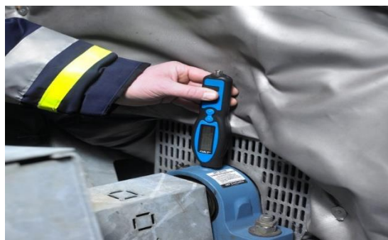
Figura 6.4 – caneta de vibração em utilização. FONTE: Catálogo SKF CMAS 100
