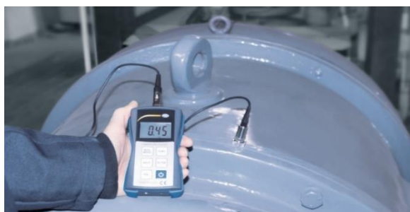
Figura 6.3 – vibrômetro em utilização.
