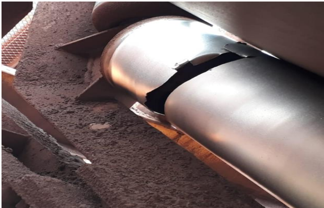
Figura 18: Rolo com revestimento quebrado (Autor, 2019)
