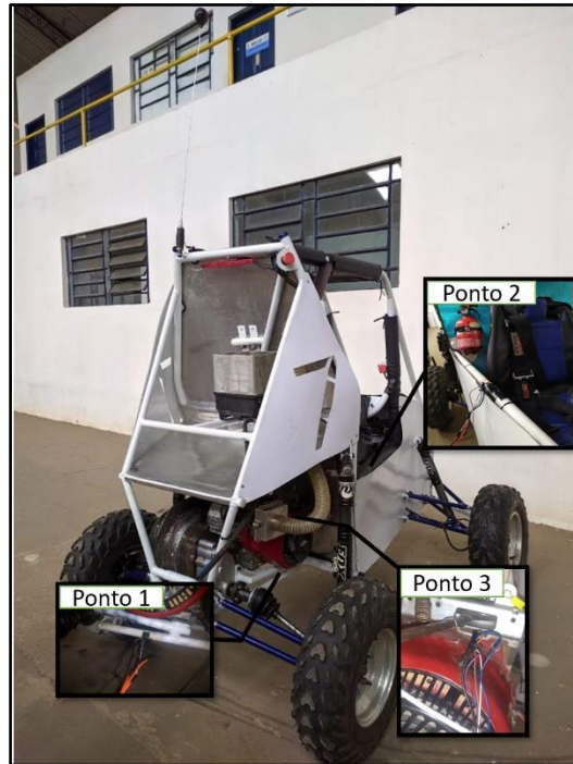
Figura 3.6. Sensor acoplado em (Ponto 1) suporte do motor, (Ponto 2) tubo SIM do cockpit, (Ponto 3) na superfície do motor. (Autor, 2019)
