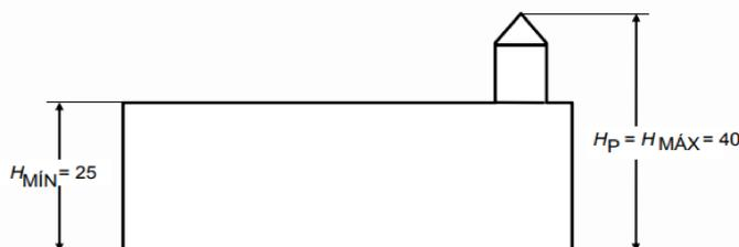
**Figura 3.** Exemplo de alturas mínima e máxima (Norma ABNT NBR 5419-2, 2015).
