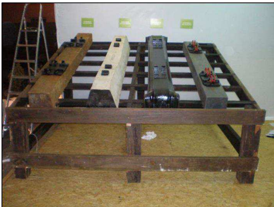
Figura 3 – Dormentes de madeira, concreto, aço e plástico.
