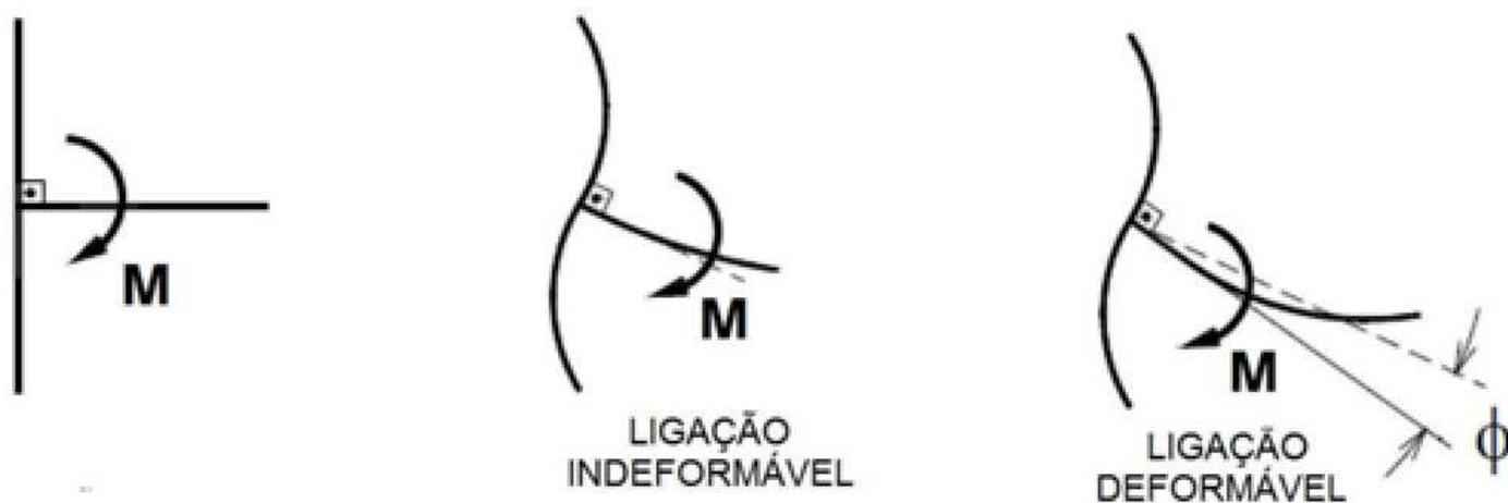
FIGURA 2.1 – Deformabilidade causada pelo momento fletor. El Debs, 2008.
