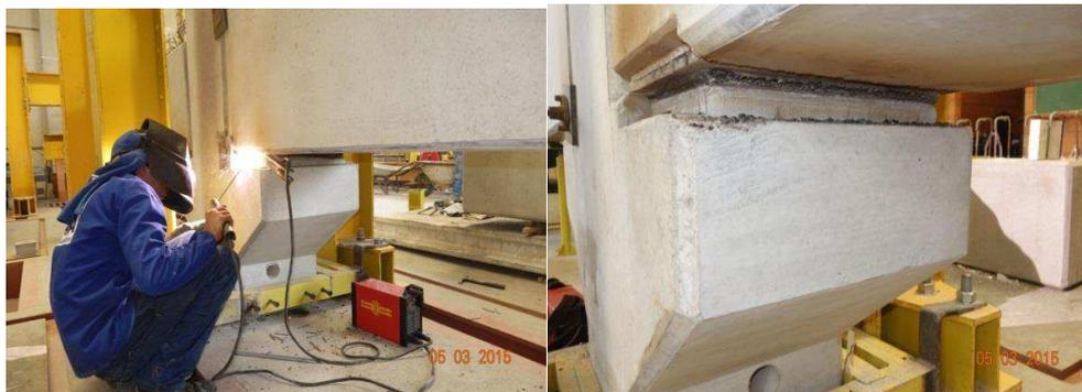
**Figura 2.12 – Exemplo de ligação viga-pilar com chapa soldada [HADADE (2016) ]**
