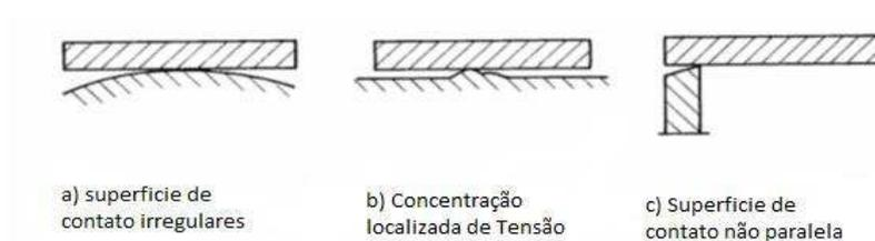
**Figura 2.13 – Superfície de contato irregulares nos apoios [FIB (2003) ]**
