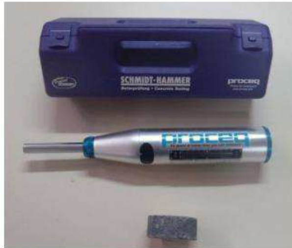
Figura 13 – Esclerômetro utilizado em ensaios de esclerometria
