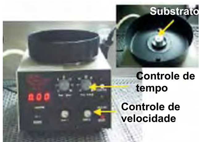
Figura 3.5: Equipamento “spin-coating” para a preparação de filmes finos por deposição de solução
