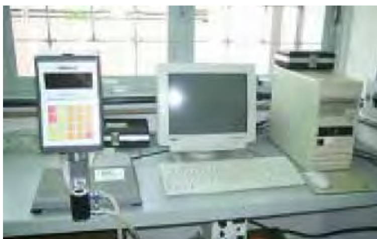
Figura 3.4: Reômetro marca Brookfield e modelo DV-III, utilizado no ajuste da viscosidade das resinas BST e BST:Sn
