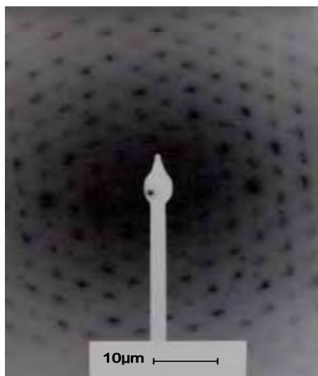
Figura 4.26: Difração de elétrons do BST:Sn-0,20 semi-cristalino (600°C/2h)
