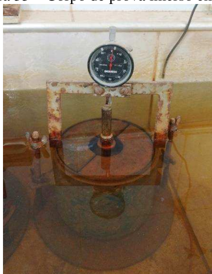
Figura 35 – Corpo de prova imerso em água
