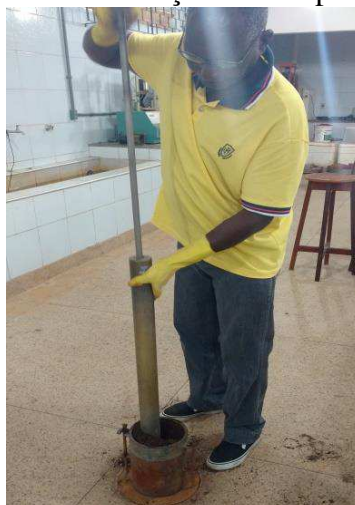
Figura 33 – Execução da compactação.
