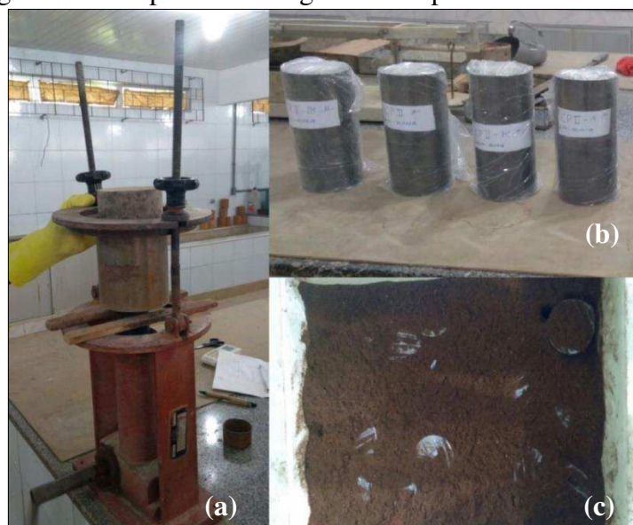
Figura 37 – Etapas de moldagem e cura para o ensaio de RCS
