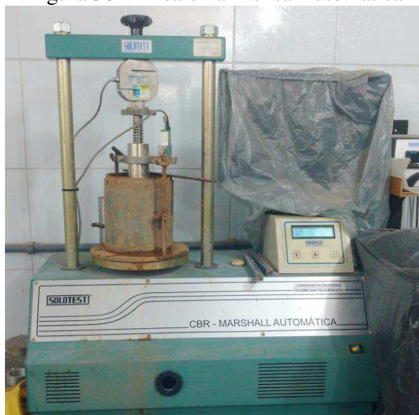
Figura 36 – Ensaio na Prensa Automática
