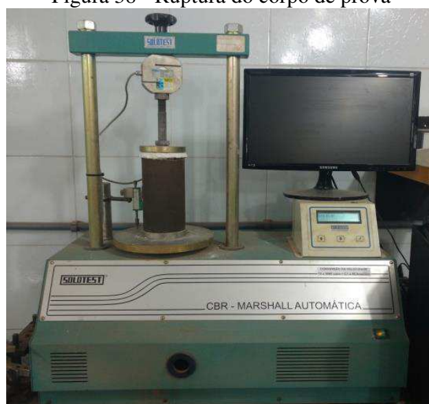
Figura 38 - Ruptura do corpo de prova
