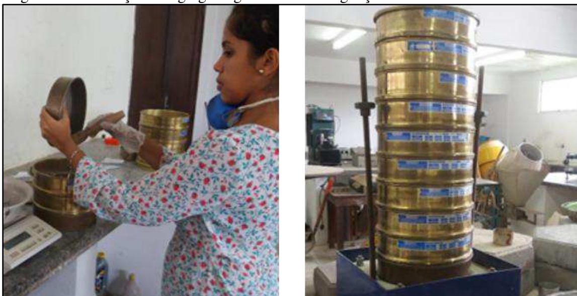
Figura 12 – Remoção do agregado gráudo retido / Agitação mecânica da brita
