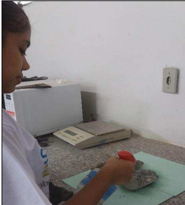
Figura 32 – Aplicação de fenolftaleína nas seções dos CPs
