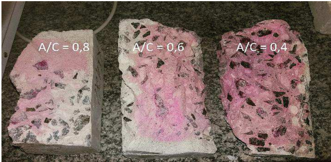
Figura 44 – Profundidade carbonatada de seções no plano longitudinal das caixas cúbicas com relação água/cimento na ordem de 0,8; 0,6; 0,4
