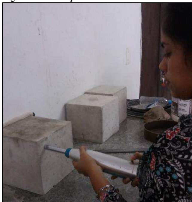
Figura 30 – Medição do índice esclerométrico
