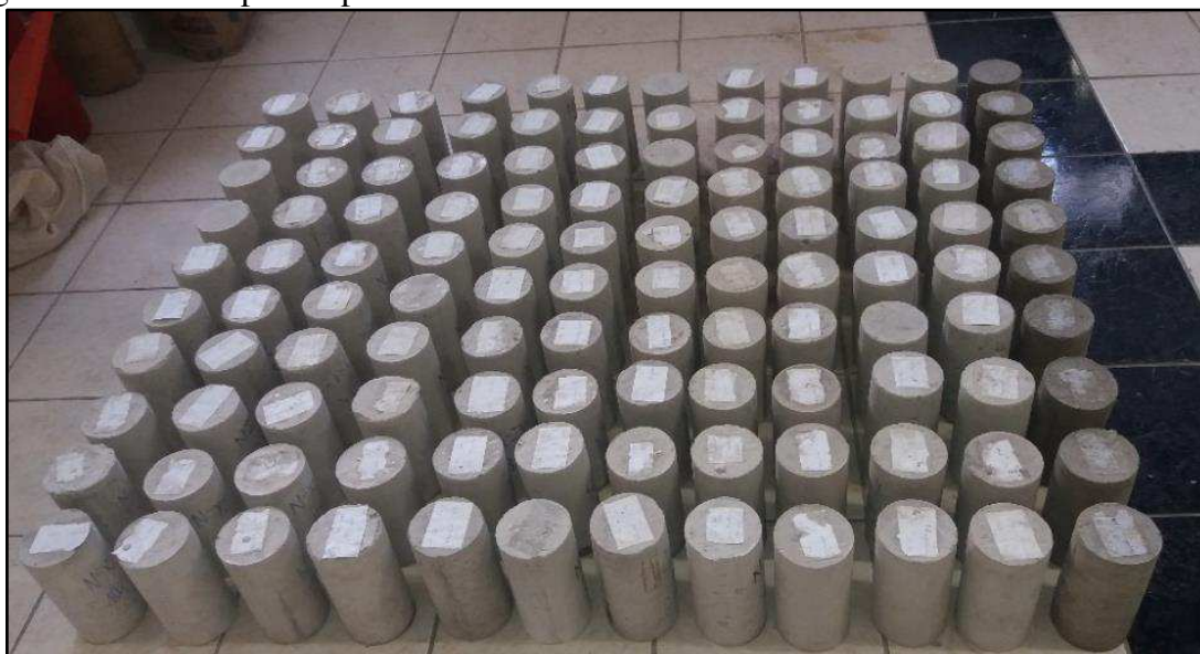
Figura 20 – 120 corpos de prova desmoldados e identificados
