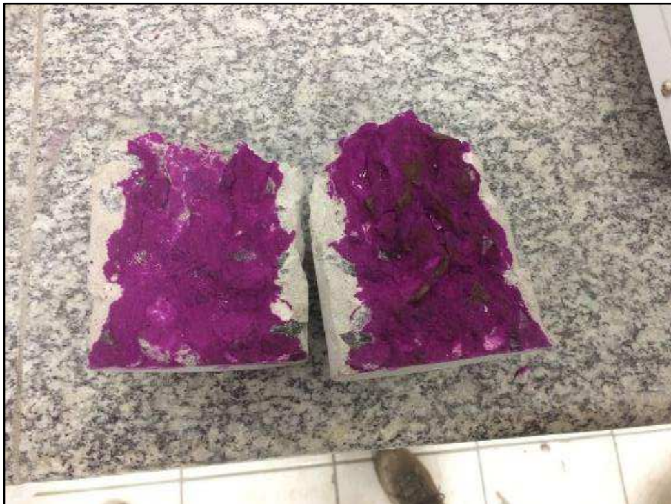
Figura 33 – Seções longitudinais do corpo de prova preparados para a medição da profundidade de carbonatação
