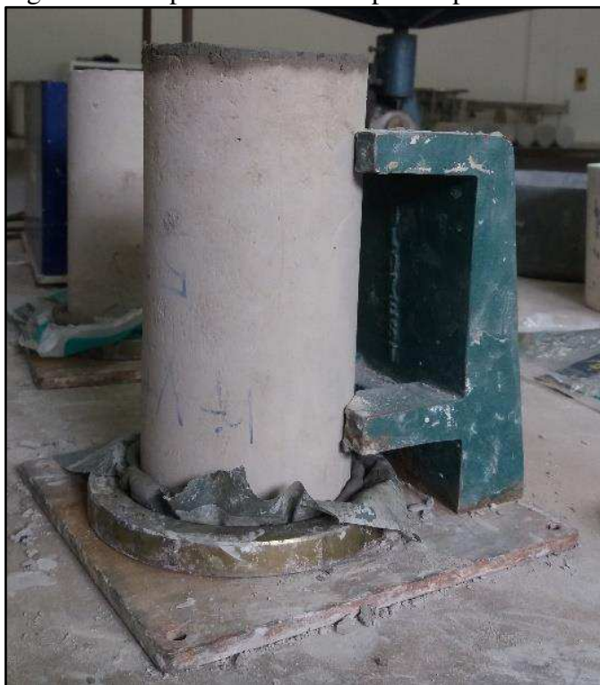
Figura 23 - Capeamento dos corpos de prova
