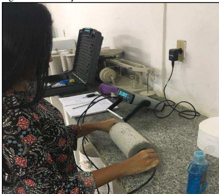
Figura 27 – Medição de velocidade das ondas ultrassônicas
