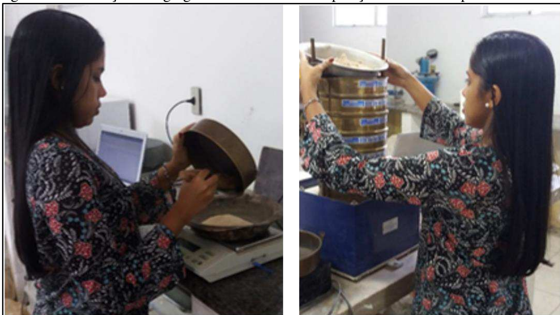
Figura 11 – Remoção do agregado miúdo retido / Disposição da areia nas peneiras
