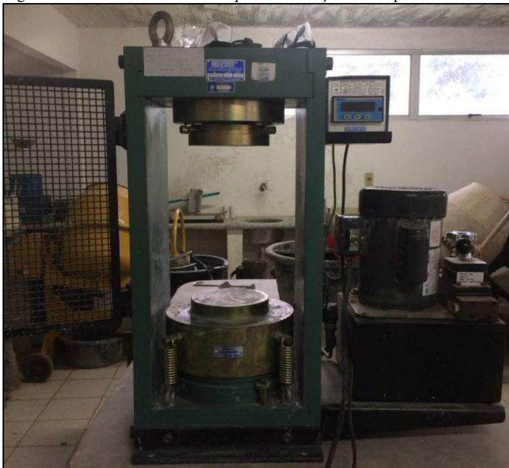
Figura 31 – Prensa eletrohidráulica para a realização do rompimento dos CP's.
