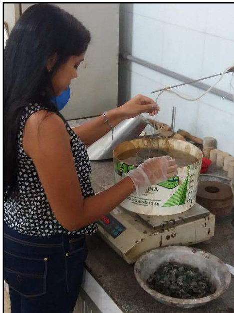
Figura 16 – Ensaio de massa específica do agregado graúdo
