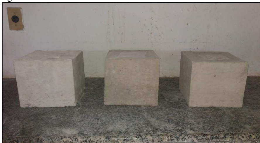
Figura 21 – Cubos de concreto de 20 x 20 x 20 cm
