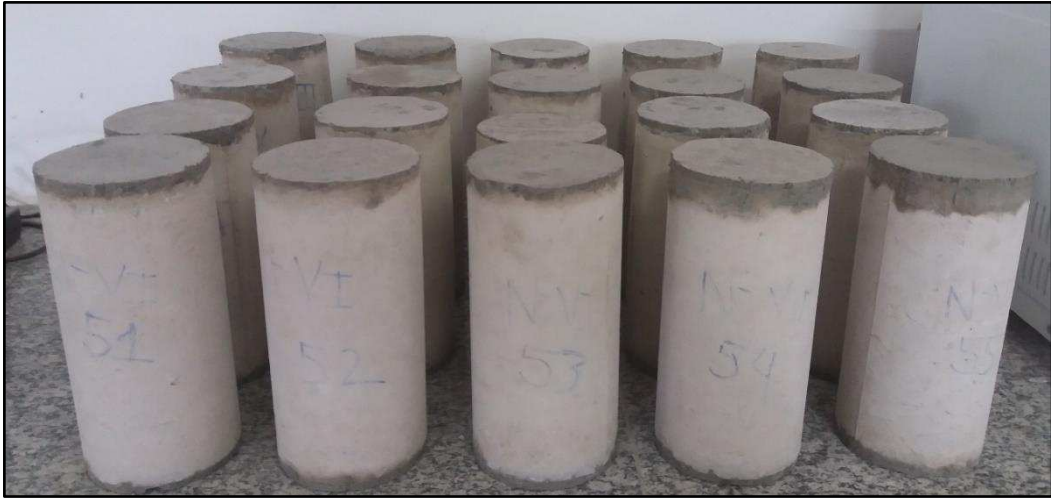
Figura 24 – Corpos de prova capeados
