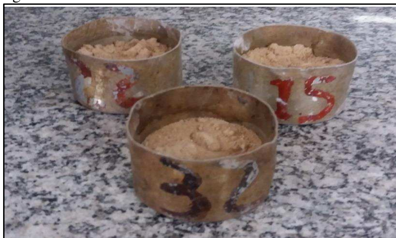
Figura 18 – Ensaio do teor de umidade
