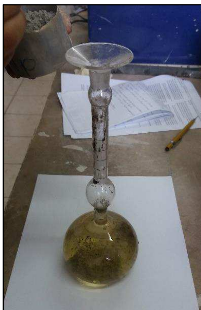
Figura 17 – Ensaio da massa específica do cimento
