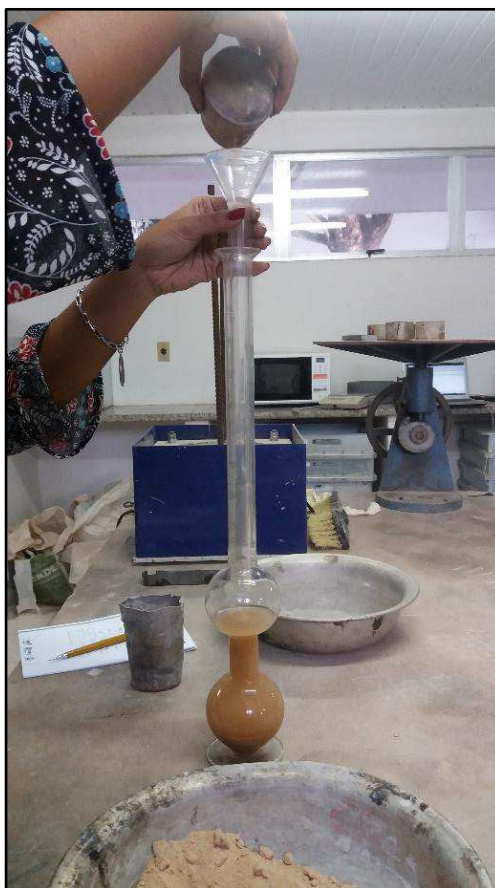
Figura 15 – Ensaio de massa específica do agregado miúdo
