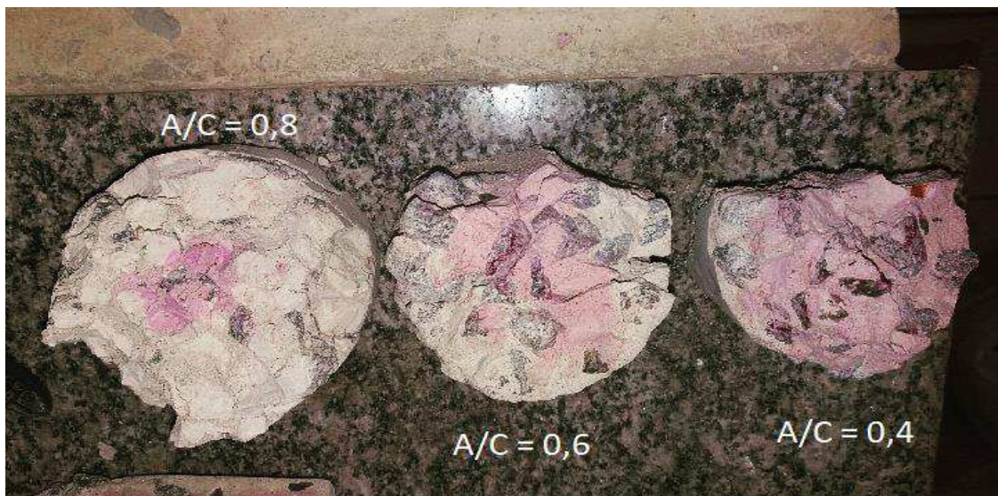
Figura 45 – Profundidade carbonatada de seções no plano transversal dos corpos de prova com relação água/cimento na ordem de 0,8; 0,6; 0,4
