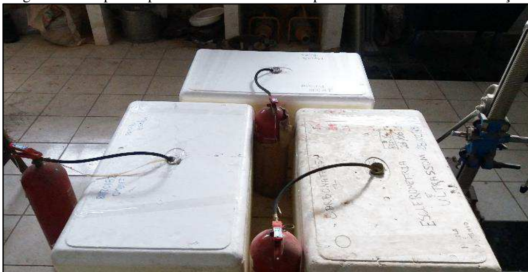
Figura 22- Corpos de prova e caixas cúbicas acoplados na câmara de carbonatação
