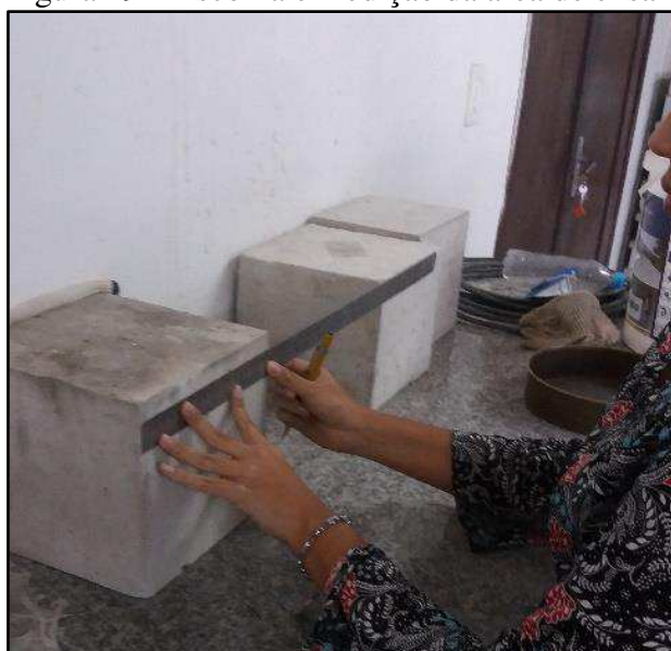
Figura 29 – Escolha e medição da área de ensaio
