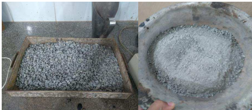
Figura 16 - Brita 0 e Pó de Brita
