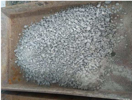
Figura 22 – Amostra após o ensaio Abrasão “Los Angeles”
