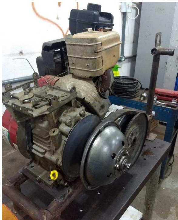
Figura 4.1. Bancada de teste para sistema powertrain .
