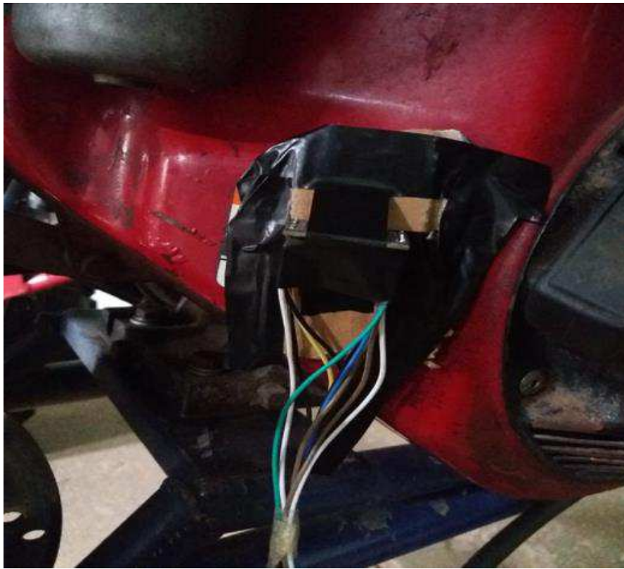
Figura 3.5. Acelerômetro acoplado no motor.
