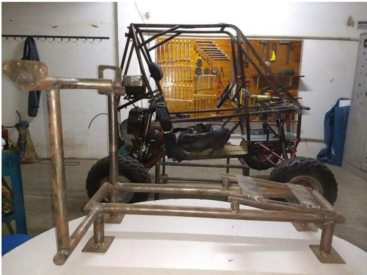
Figura 5.1. Bancada de teste e o veículo Vitasse.
