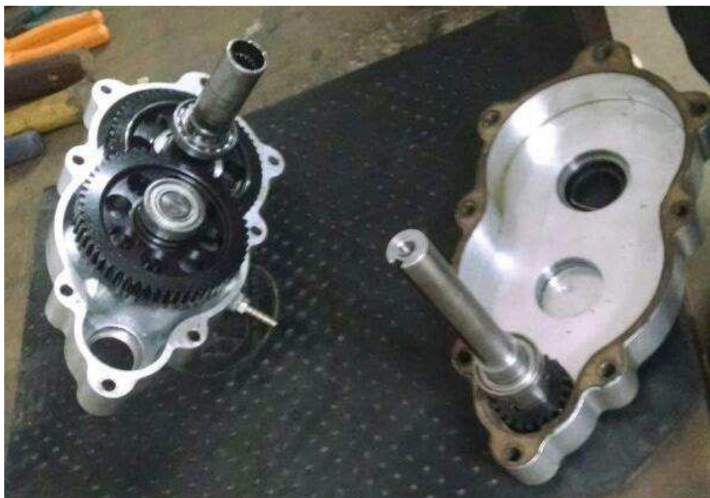
Figura 2.6. Caixa de dupla redução confeccionada.
