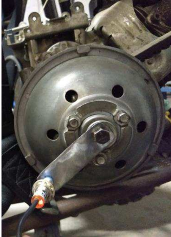
Figura 3.2. Sensor indutivo para medição de velocidade e rotação.
