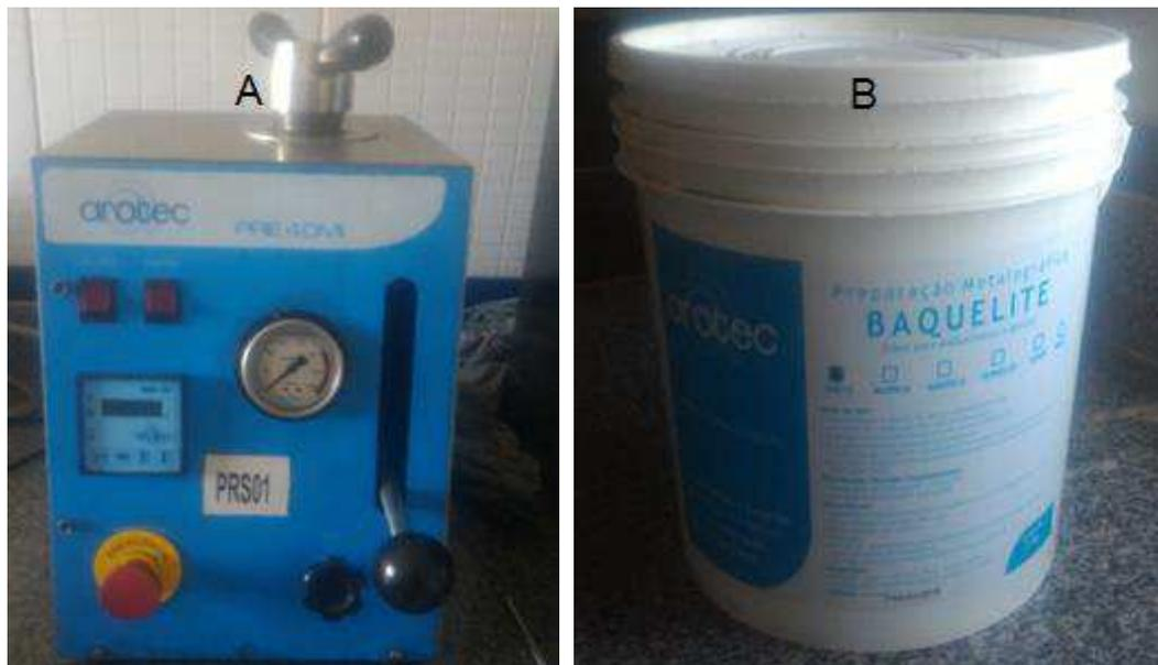
**Figura 38 - Embutidora Metalográfica e resina de baquelite. (Autor, 2018).**
