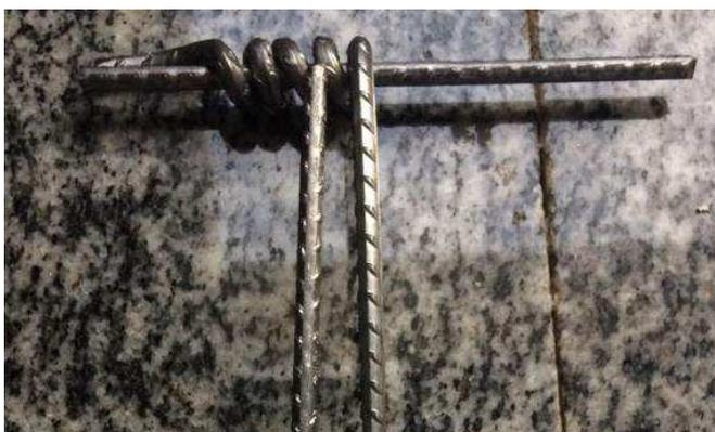
**Figura 36 - Amostra do vergalhão pós ensaio de dobramento (Autor, 2018).**
