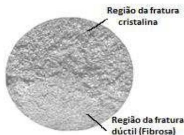
Figura 8 – Exemplo de material que falhou por fadiga. (Callister, 2007).
