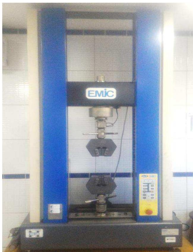
**Figura 33 - Máquina de Ensaio Mecânico Universal utilizada. (Autor, 2018).**
