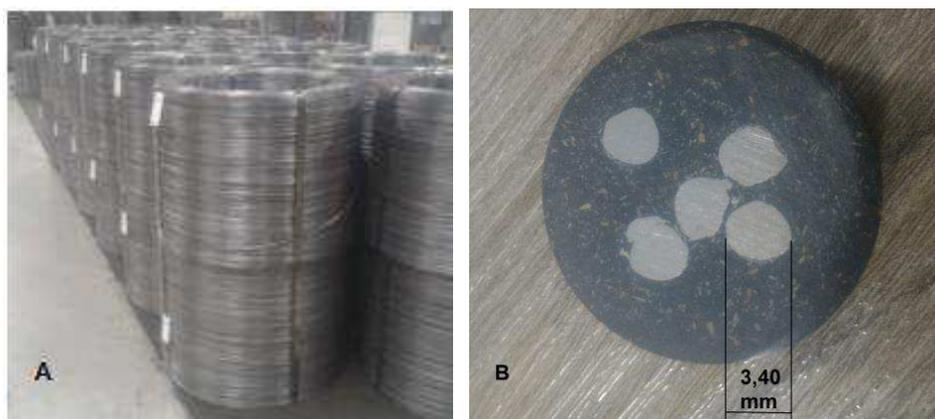
**Figura 20- (A) Bobinas de aço laminado a frio (B) Corpo de prova do produto final embutido. (Autor, 2018).**
