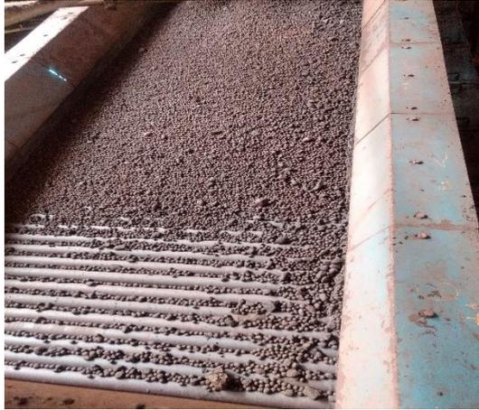
Figura 19. Peneira de rolos na descarga do disco.
