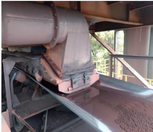
Figura 66. Terceiro ponto de captação de material particulado.
