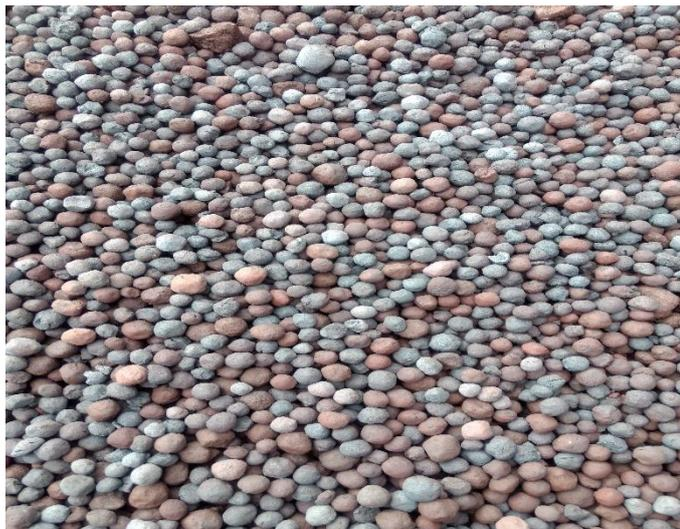
Figura 5. Pelotas, matéria prima para fabricação do aço.
