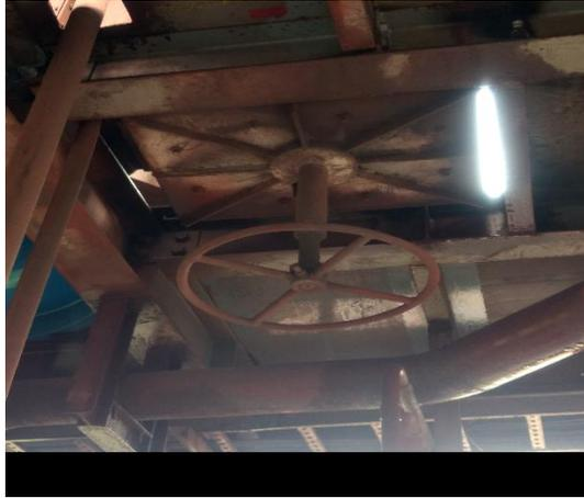
Figura 74. Dispositivo de regulagem para passagem dos gases no venturi.
