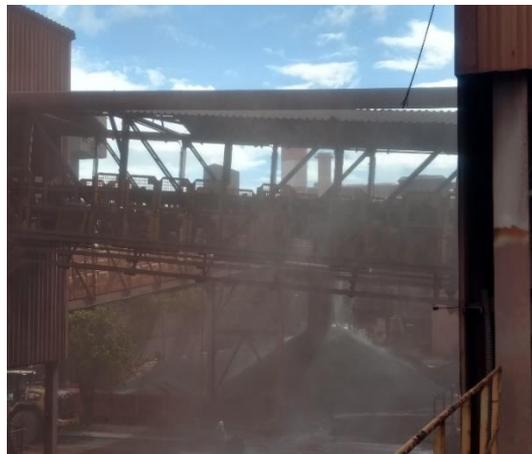
Figura 38. Material particulado gerado na saída do peneiramento.
