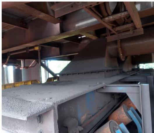
Figura 64. Segundo ponto de captação, na transferência de pelota entre transportadores.
