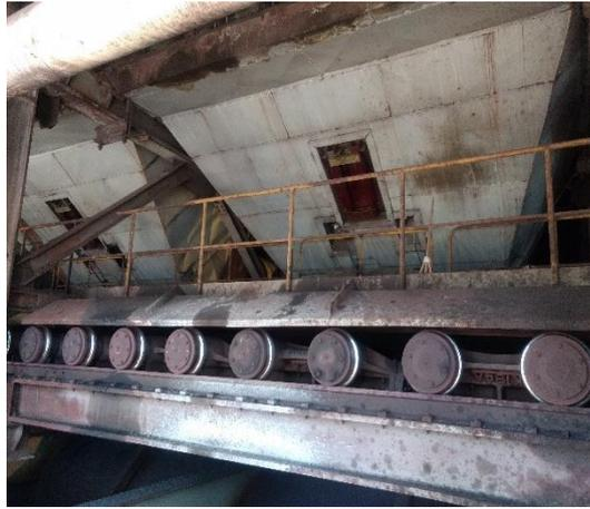
Figura 21. Transporte de pelotas pelo forno com carro grelha.
