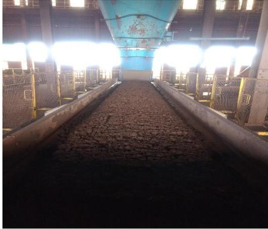
Figura 17. Balança dosadora.
