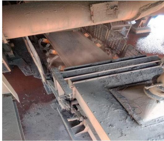
Figura 35. Geração de material particulado na descarga do chute.
