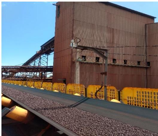
Figura 92. Pirômetro monitorando temperatura de pelotas.
