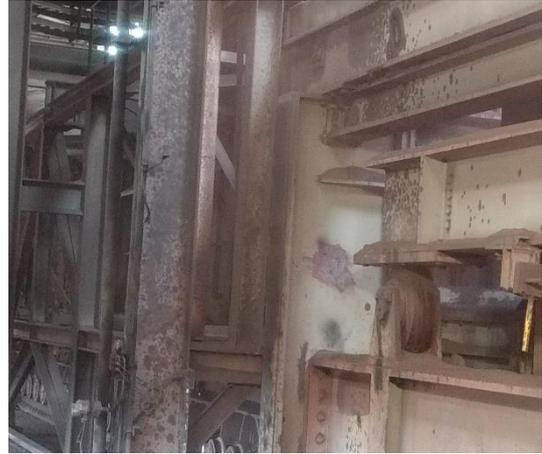
Figura 37 (b). Material particulado na lateral da peneira.
