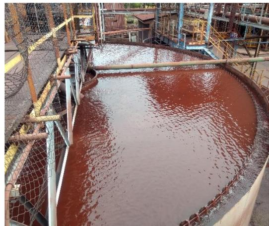
Figura 79 (b). Vista superior do Espessador.
