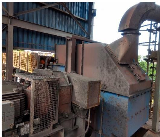
Figura 62. Primeiro ponto de captação de material particulado do lavador de gases.
