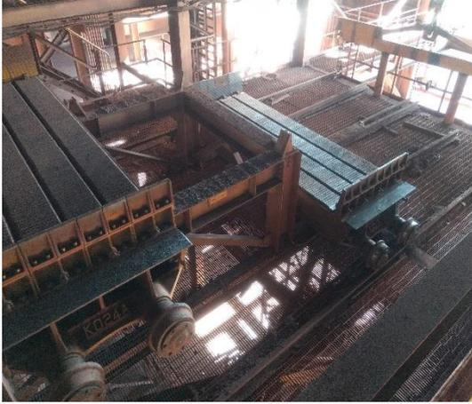
Figura 28 (a). Preparação do carro de grelha para receber a camada de forramento.
