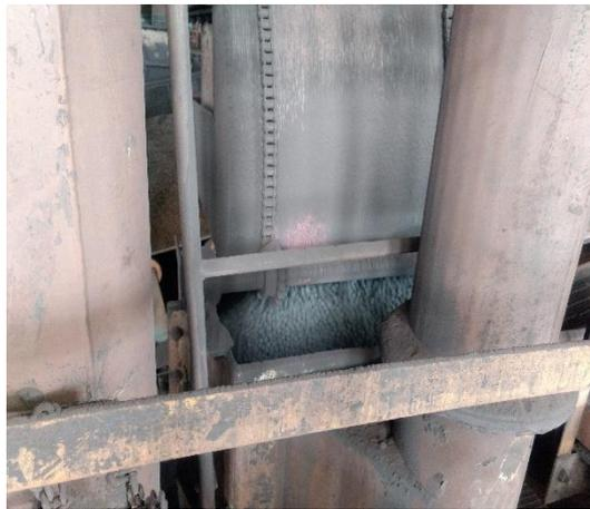
Figura 27. Ponto de captação de particulado na entrada do forno.
