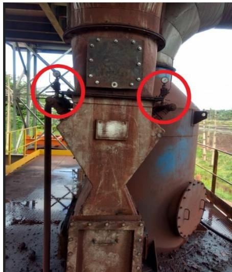
Figura 72. Bicos Sprays para sistema de aspensão do venturi.
