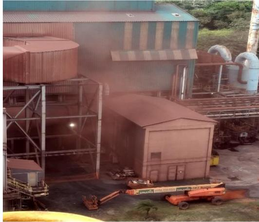
Figura 32. Material particulado gerado sem o uso do Lavador.
