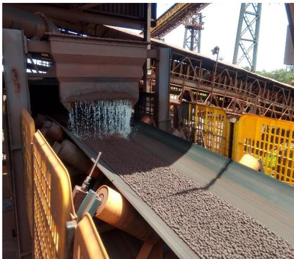
Figura 100. Aplicação do supressor na correia transportadora.
