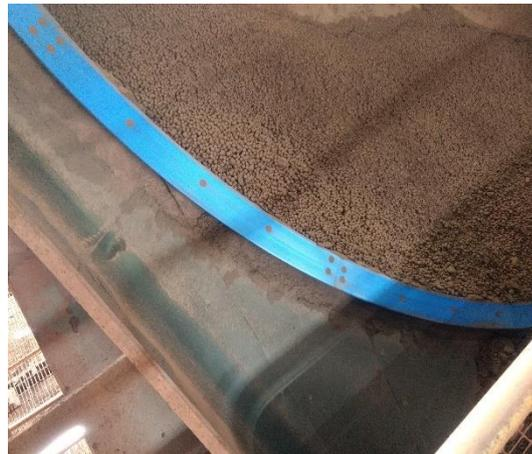
Figura 18. Pelotas na descarga do disco.
