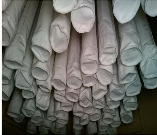
Figura 49. Mangas, elemento filtrante.
