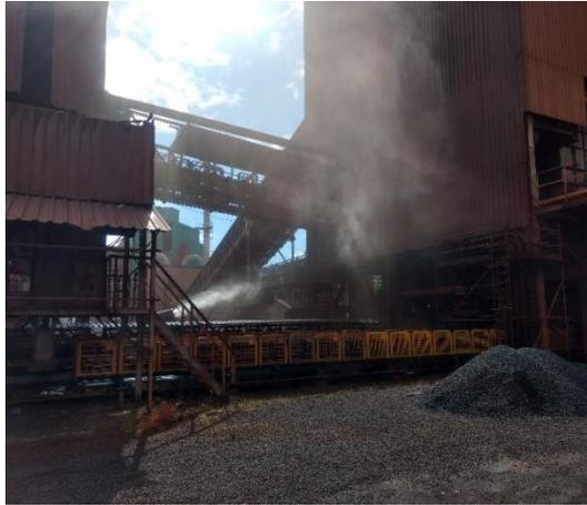
Figura 39. Ventilador com jatos d'água usados no processo.
