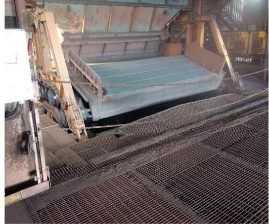
Figura 28 (b). Giro do carro grelha no forno.
