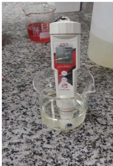
Figura 4.10 - Medidor de pH.
