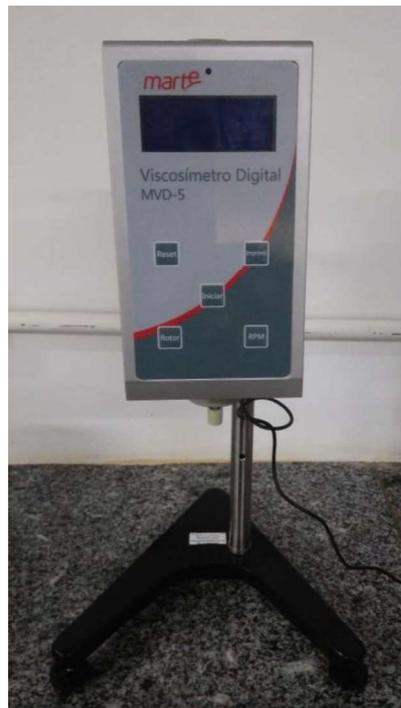
Figura 4.6 - Viscosímetro digital.
