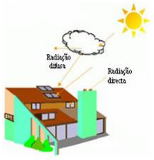
Figura 3.3 - Ilustração da radiação difusa e direta. (Adaptado de Strom Brasil 1 )
