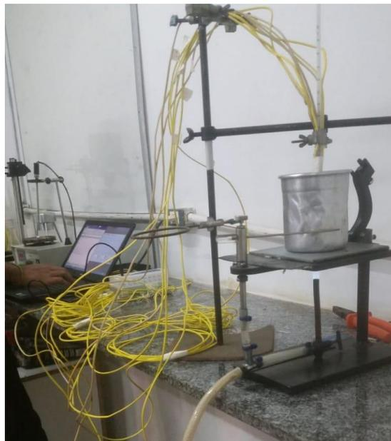
Figura 3.9 – Calibração dos termopares (AUTOR, 2019)
