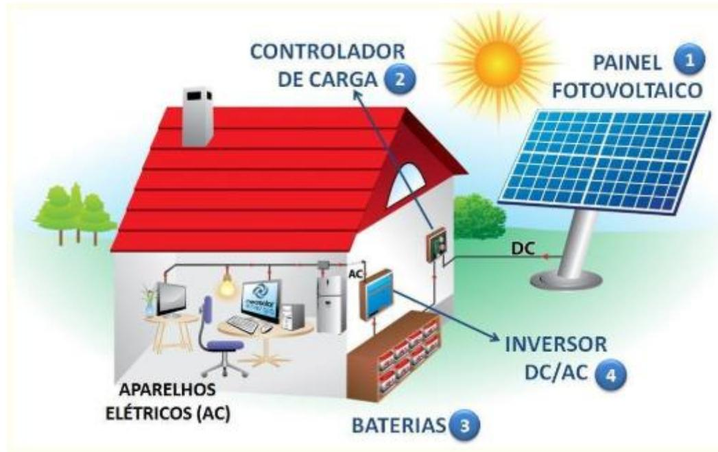
Figura 2.8 - Sistema isolado (Adaptado de NEOSOLAR, s.d.)
