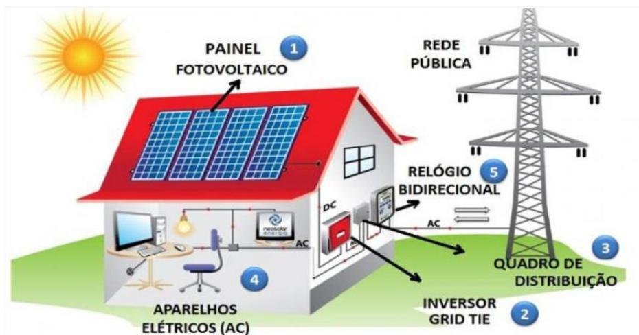
Figura 2.6 - Sistema ligado à rede elétrica (Adaptado de NORTAOENERGIASOLAR, s.d.)
